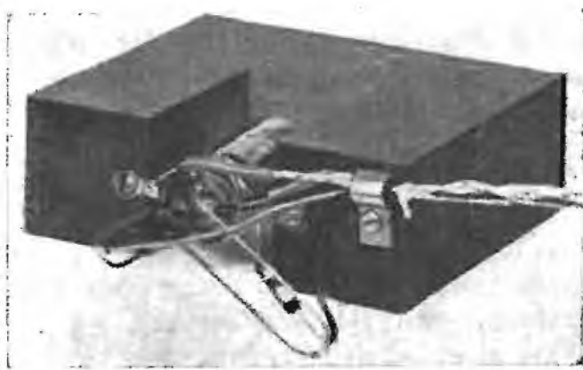
Fig. 2 - L'oscillatore è montato su un blocco di legno.
