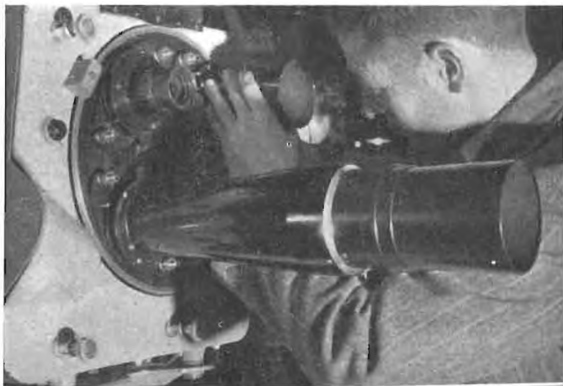
Camera da presa televisiva costruita in Inghilterra per l'esportazione. La torretta porta tre obiettivi, fra cui un teleobiettivo.
