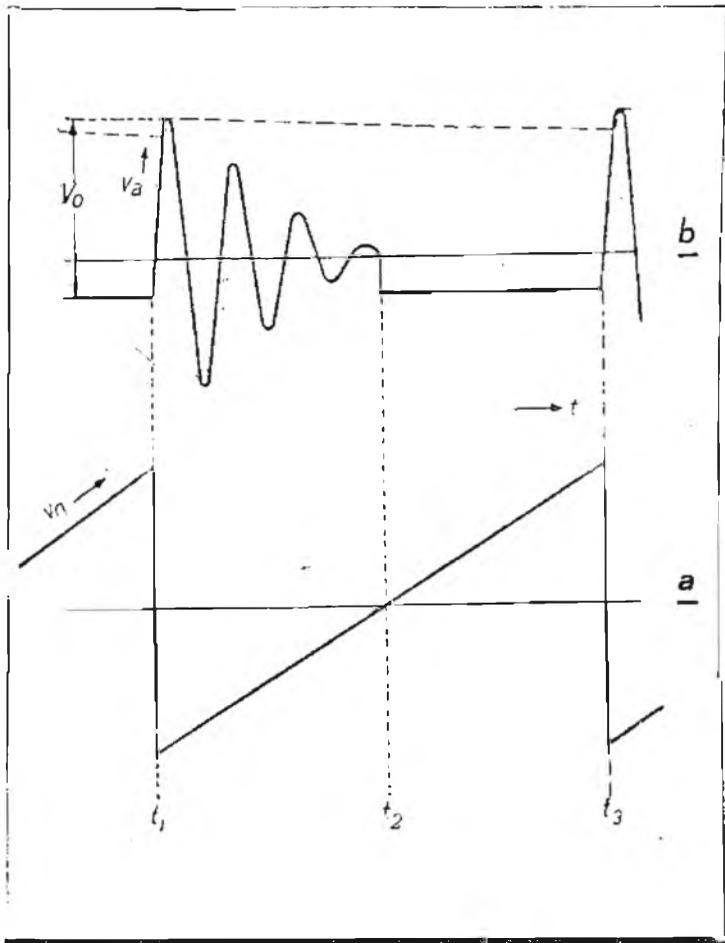
Fig. 3 - In a la tensione a denti di sega applicata alla griglia e in b la corrente anodica risultante. Nell'intervallo  $t_1-t_2$  la valvola è interdetta e, venendo interrotta la corrente anodica, l'energia immagazzinata nell'induttanza dà luogo ad un'oscillazione.  $V_0$  rappresenta la tensione rettificata.
