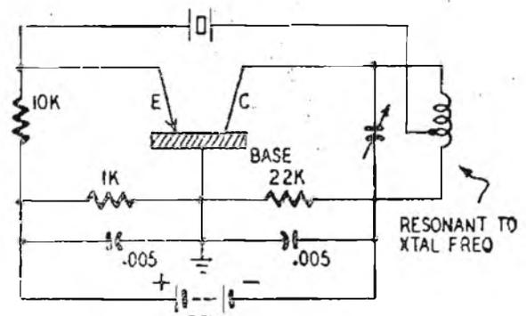
Fig. 2 - Oscillatore AF con transistor che fornisce una potenza d'uscita di 10 mW.
