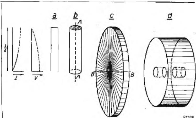
Fig. 2 - Linee di trasmissione e cavità risonanti. a) Linea 1/4 d'onda; ruotando questa linea intorno all'asse AA si ottiene la linea concentrica b, mentre ruotando la linea intorno all'asse BB si ottiene il risonatore c. In d un risonatore provvisto di fori per il passaggio del fascio elettronico.
