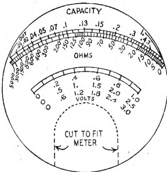
Fig. 3 - Scala dello strumento.
