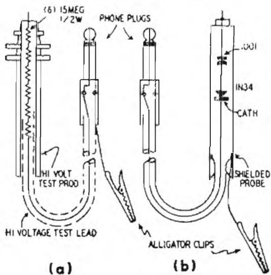
Fig. 1 a - Probe per alta tensione; esso comprende sei resistenze da 15 M-ohm e consente misure di tensione sino a 10.000 V.
