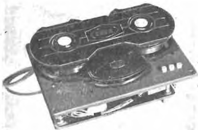
Fig. 3. Complesso meccanico R3C3/A con comando a pulsanti.
