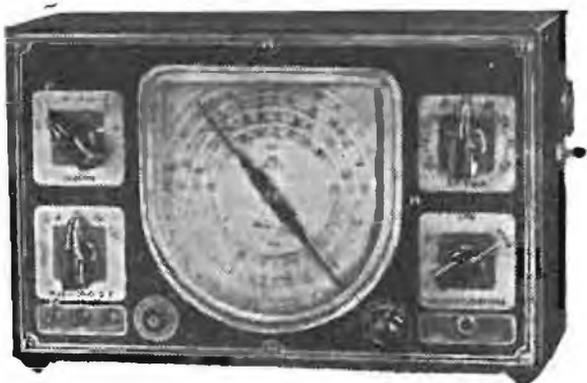
6 gamme d'onda da 25 MHz a 90 kHz ( $12 \frac{1}{3}$  3100) - 1 gamma a BANDA ALLARGATA per la taratura della MF. - Ampia scala a lettura diretta in kHz, MHz e metri. - Taratura Individuale "punto per punto", - Modulazione della R. F. con 4 frequenze diverse 200/400/600/800 periodi. - Attenuatore ad impedenza costante. - Alimentazione in alternata 110/125/140/160 220 V. - Dimensioni mm 280 x 170 x 100.
