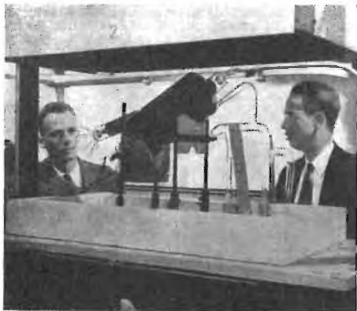
Questa strana valvola è il memory tube, cioè la valvola della memoria che è in grado di "ricordare" sino a 400 cifre e che trova impiego specialmente nelle moderne calcolatrici elettroniche. Nella foto J. W. Forrester ed S.H. Dodd della MIT Servomechanism Labs. dalla quale è stata progettata e costruita la nuova valvola. (Radio Electronics).
