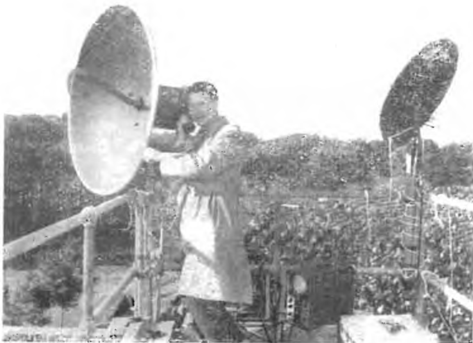
Attrezzata di tutto punto, una stazione mobile riprende sul posto gli avvenimenti sportivi e li trasmette (con le antenne paraboliche a destra ed a sinistra) alla stazione principale che le irradierà nuovamente.
