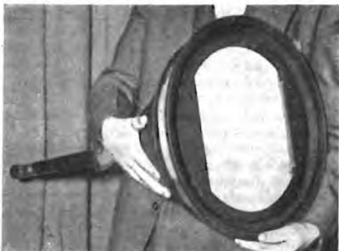
Tubo tricolore RCA per il sistema di televisione a colori da questa proposto.
