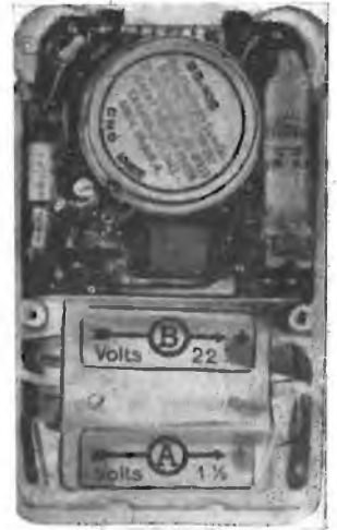
Disposizione dei vari componenti nell'interno dell'apparecchio per sordità che si descrive.
