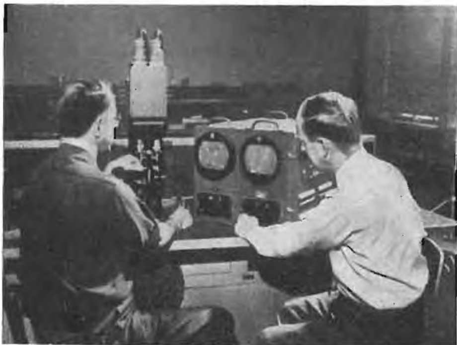
Televisione stereoscopica ottenuta accoppiando due apparecchi televisivi; è possibile, unendo le camere ad un microscopio, ottenere delle immagini a rilievo dei preparati.
