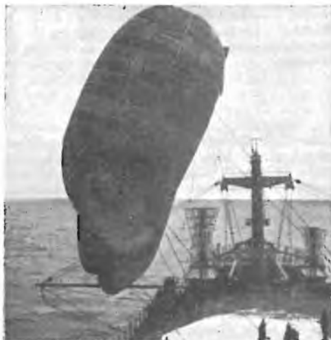
Uno dei palloni frenati che serve ad innalzare le antenne trasmettenti del « Courier », la nave che rappresenta la stazione navigante della Voce dell'America.
