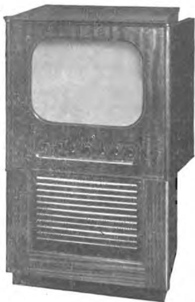
**TX. 1714 A.** Televisore a proiezione; quadro da 23" (cm. 45x33,7); 33 valvole serie speciale per TV; selettore per tutti i canali italiani; alimentazione in C. A. a 220 V.
