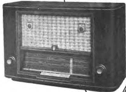
**BX. 633 A.** Supereterodina AM/FM; 9 valvole Miniatura e Noval più occhio magico; 4 gamme d'onda di cui una FM; comandi a tastiera; antenna in Ferroxcube orientabile; presa per fon.
