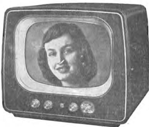
**TI. 1720.** Quadro da 17" (cm. 36,5x27,2) 22 valvole serie speciale per TV; selettore per tutti i canali italiani; alimentazione in C. A. a 110, 125, 140, 160, 170 e 220 V.
