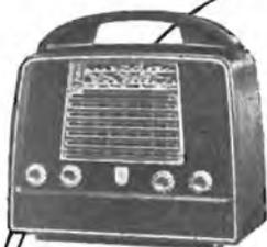
**LI. 422 AB.** Alimentazione su rete C. A. ed a batterie; 5 valvole; 3 gamme d'onda; dispositivo rigenerazione batterie; di comodo e facile trasporto
