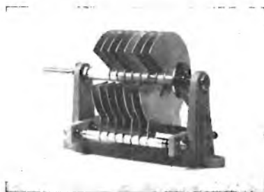
Mod. 644 - 100 pF, spaziatura fra le lamine 3 mm.
