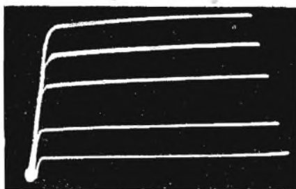
Fig. 3 — Famiglia di curve della corrente di collettore rispetto alla tensione di collettore per un transistor Reytheon CK722 con correnti di base di 25, 50, 100, 150 e 200 \mu A.
