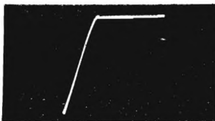
Fig. 4 — Curva caratteristica di un diodo di germanio 1N34 rilevata col medesimo circuito.
