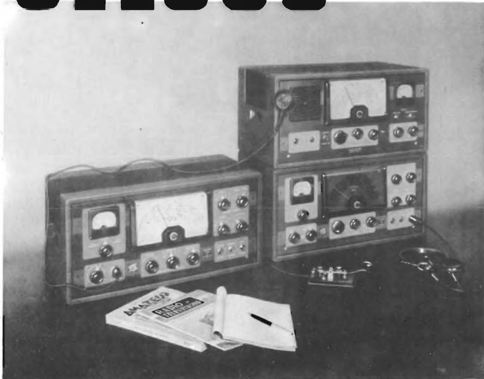
**TRASMETTITORE G 210-TR** - 25 watt di potenza RF - VFO pilota - Alimentazione con c. a. di rete - Fonia - Grafia.
