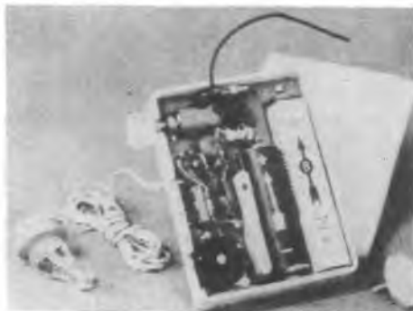
Il piano sul quale viene appoggiato il ricevitore può essere fatto ruotare per determinare la direzione di provenienza del segnale:
