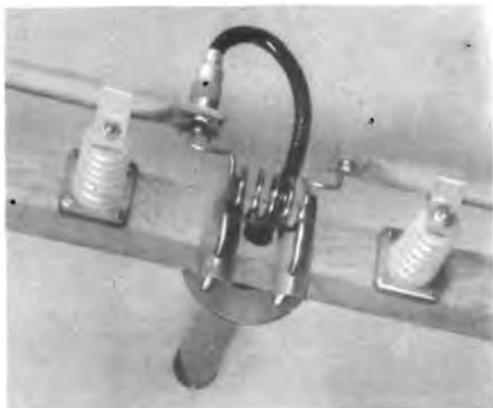
Particolare del fissaggio dei semi-dipoli, dell'induttanza e del cavo di discesa.
