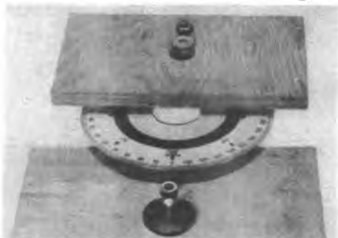
Il piano sul quale viene appoggiato il ricevitore può essere fatto ruotare per determinare la direzione di provenienza del segnale:
