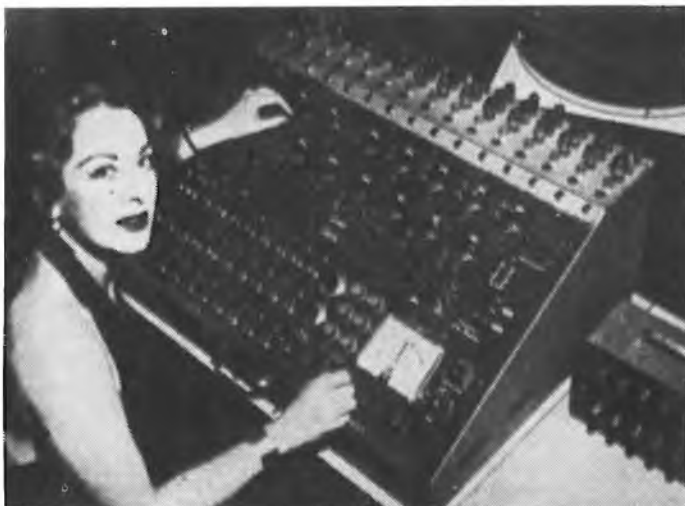
La Heath Co. ha messo in commercio il suo più grande « kit », una calcolatrice analogica destinata a scuole, laboratori e organizzazioni di ricerca. La scatola di montaggio, che costa circa 750 dollari, comprende 6.000 pezzi, 65 valvole, 5 relè e 35 diodi. (Radio Electronics)
