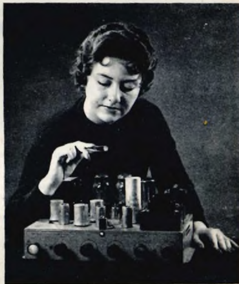
Fig. 1 - Il piccolo oggetto rotondo che la presentatrice tiene sollevato con una pinza ha press'a poco le dimensioni di una nostra moneta da 10 lire e costituisce un amplificatore molecolare elettronico svolgente esattamente la stessa funzione dell'amplificatore a valvole di tipo convenzionale posto sul tavolo. Con la nuova tecnica molte apparecchiature sarebbero suscettibili di un rimpicciolimento pari ad 1/1000 , cioè 1000 volte più piccole.
