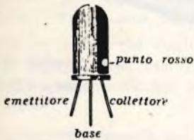
Fig. 8 - Indicazione della posizione degli elettrodi del transistor OC 71.
