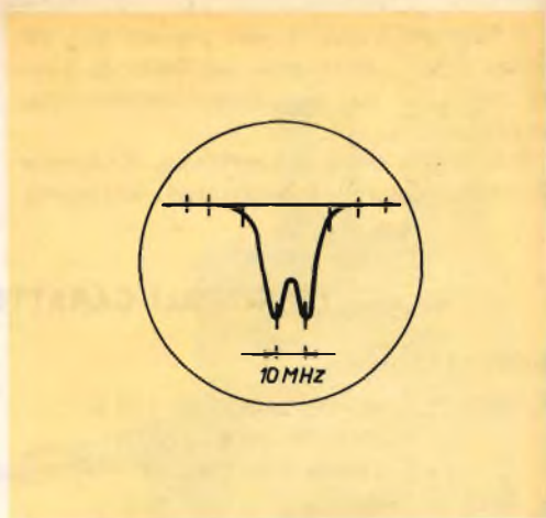
Fig. 5 - Curva di risposta sull'oscillografo in corrispondenza delle frequenze alte (790 MHz)
