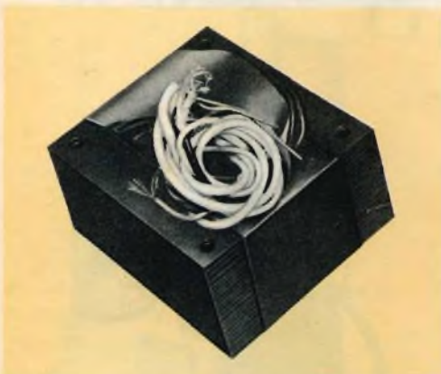
Fig. 1 - Trasformatore d'alimentazione M/381.
