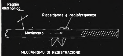
Fig. 4 - Meccanismo di registrazione.
