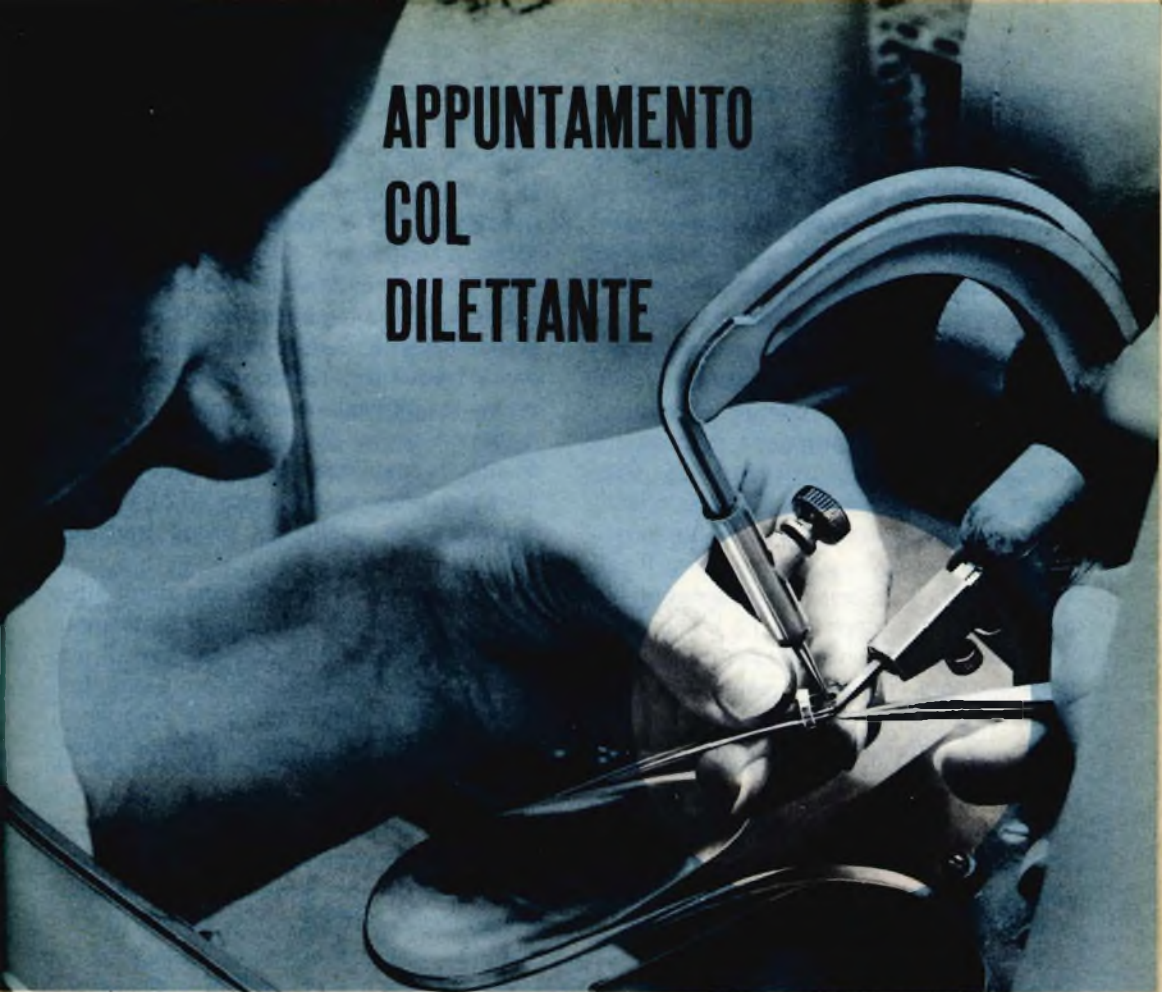
Saldatura dei terminali di un transistor di potenza Philips
