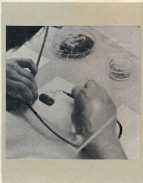
Fig. 4 - I contenitori dove vengono deposte le piastrine di germanio sono di grafite.
