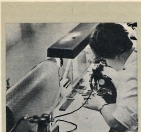
Fig. 3 - Le sferette di indio destinate a formare il collettore e l'emettitore vengono deposte sulle piastrine di germanio monocristallino fissate su appositi contenitori di grafite.
