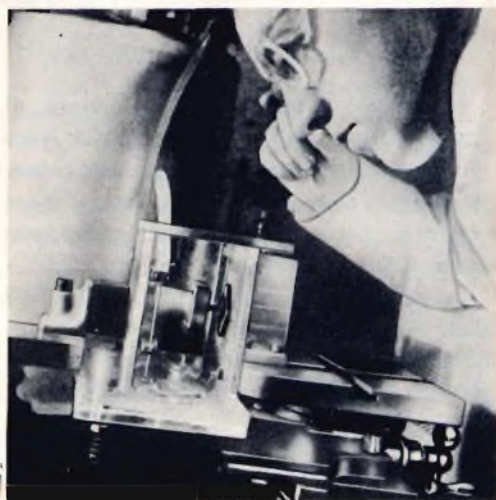
Controllo della macchina che « affetta » le piastrelle di germanio destinate a diventare la base nei transistor a lega.
