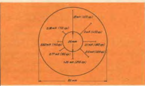
Fig. 18 - Bobina corta a più strati di forma solenoide (sezione trasversale). Sono indicati in scala i riempimenti corrispondenti alle varie induttanze.
