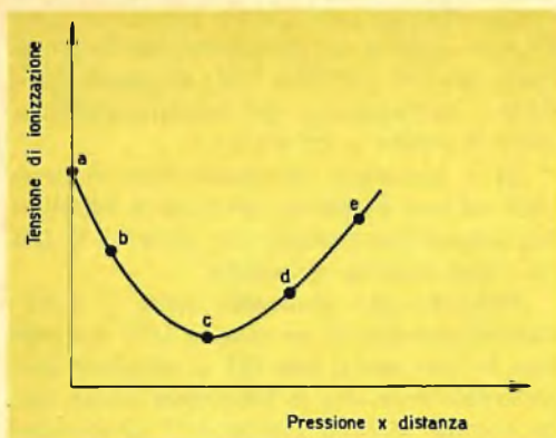
Fig. 14 - Tensione di ionizzazione in funzione del prodotto pressione x distanza (legge di Paschen).
