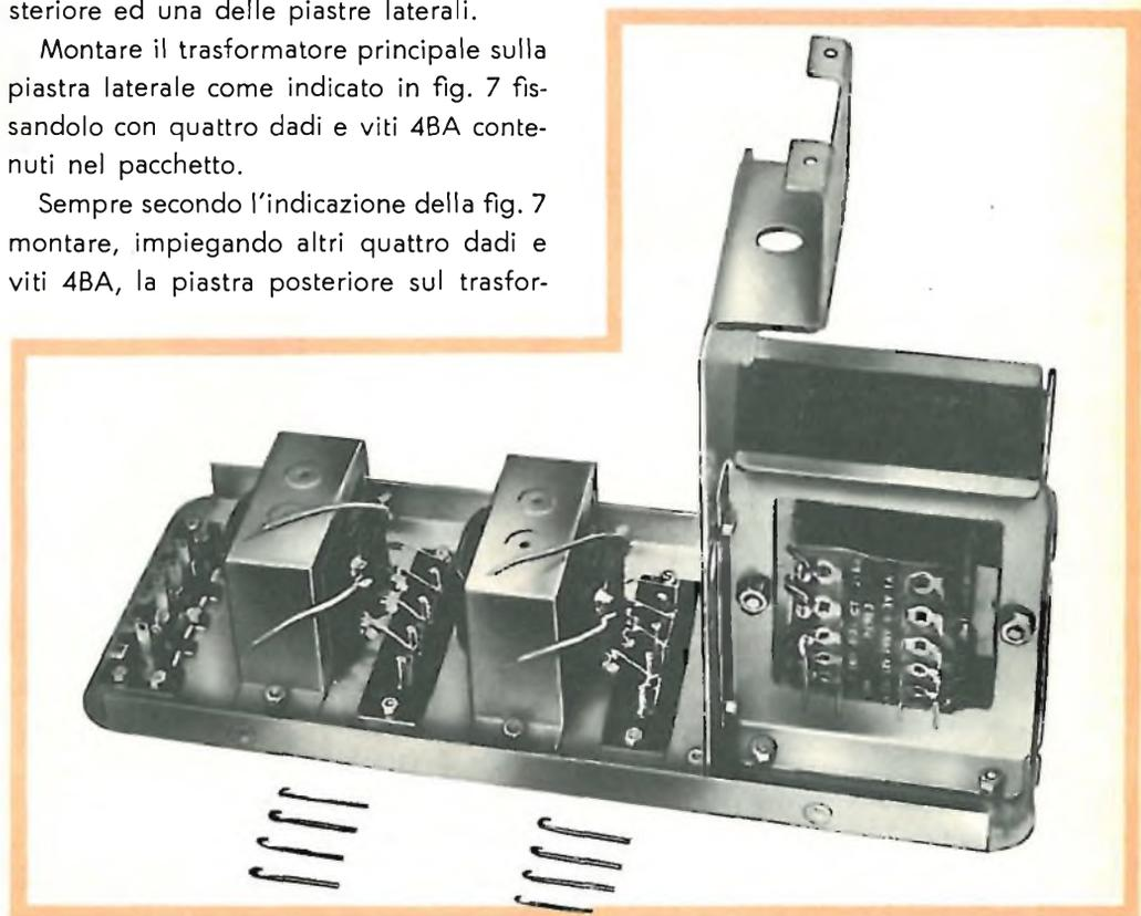
Fig. 7 - Prima fase del montaggio del 2° stadio.
