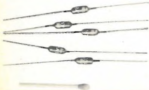
Diodi al germanio da impiegare come demodulatori in radio e TV.
