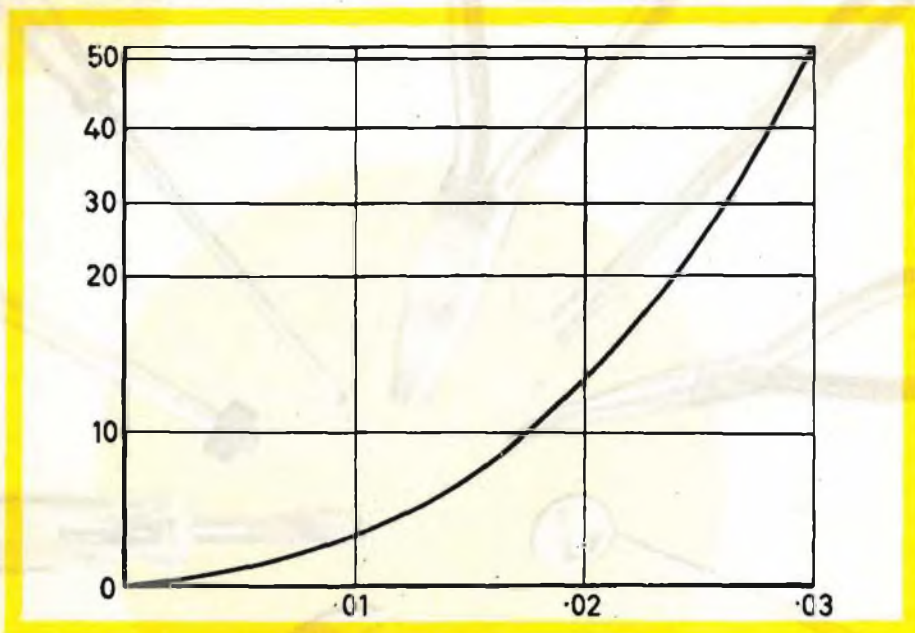
Fig. 10 - Distanza tra i contatti (in pollici). Grafico indicante la resistenza dell'ELECTROLUBE N. 2 CON SEPARAZIONE a 20°C. Non vi è passaggio di corrente. Diametro del contatto: 240".
