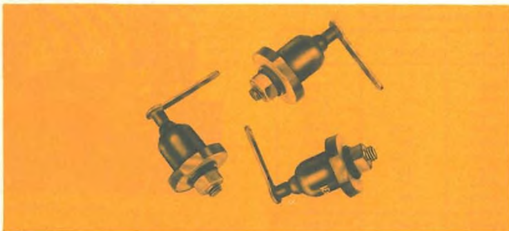
Raddrizzatori di germanio OAS1 (Philips). Possono sopportare una tensione inversa di 85 V e fornire una corrente diretta di 12 A. Vengono di solito impiegati nelle apparecchiature per la ricarica degli accumulatori.
