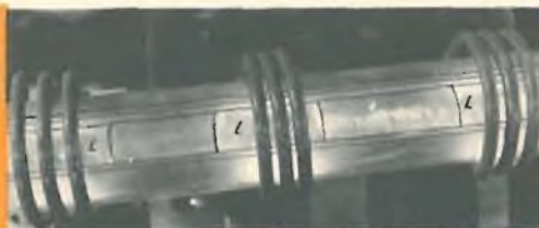
Particolare del tubo in cui si trova il germanio fuso. Si notano le spire percorse da correnti di R.F. e le zone fuse (L) lunghe da 4 a 5 cm.
