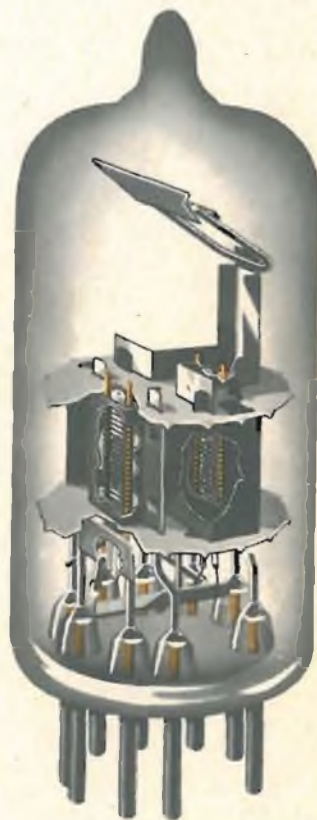
Doppio triodo Philips per alta frequenza E/PCC 189 a pendenza variabile. E' stato asportato una parte di anodo per mettere in evidenza gli altri elettrodi (griglia a telaio, catodo, filamento).
