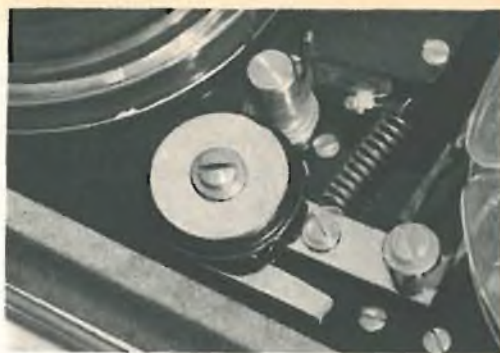
Nel magnetofono portatile Stellavox le testine di riproduzione e di registrazione come pure la puleggia di trascinamento del nastro sono sistemate tra le due bobine portanastro.
