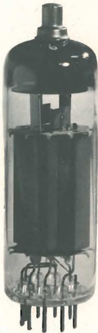
Nuovo pentodo con "anodo a labirinto" PL 500 (Philips).
