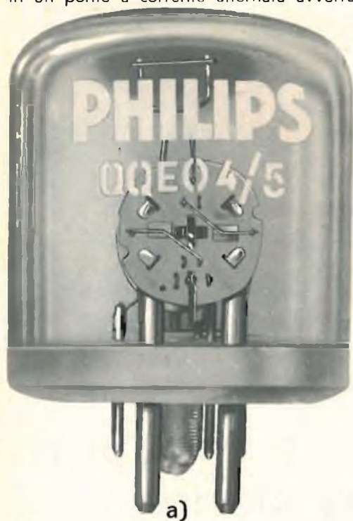
Doppio tetrodo QQE 04/5 (Philips) da impiegare come oscillatore e amplificatore in UHF a) visto di fronte, b) visto lateralmente.
