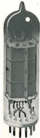
Valvola vuotata con getter evaporato
