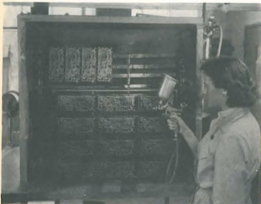
Flussaggio di pannelli a circuiti stampati, effettuato con areografo.
