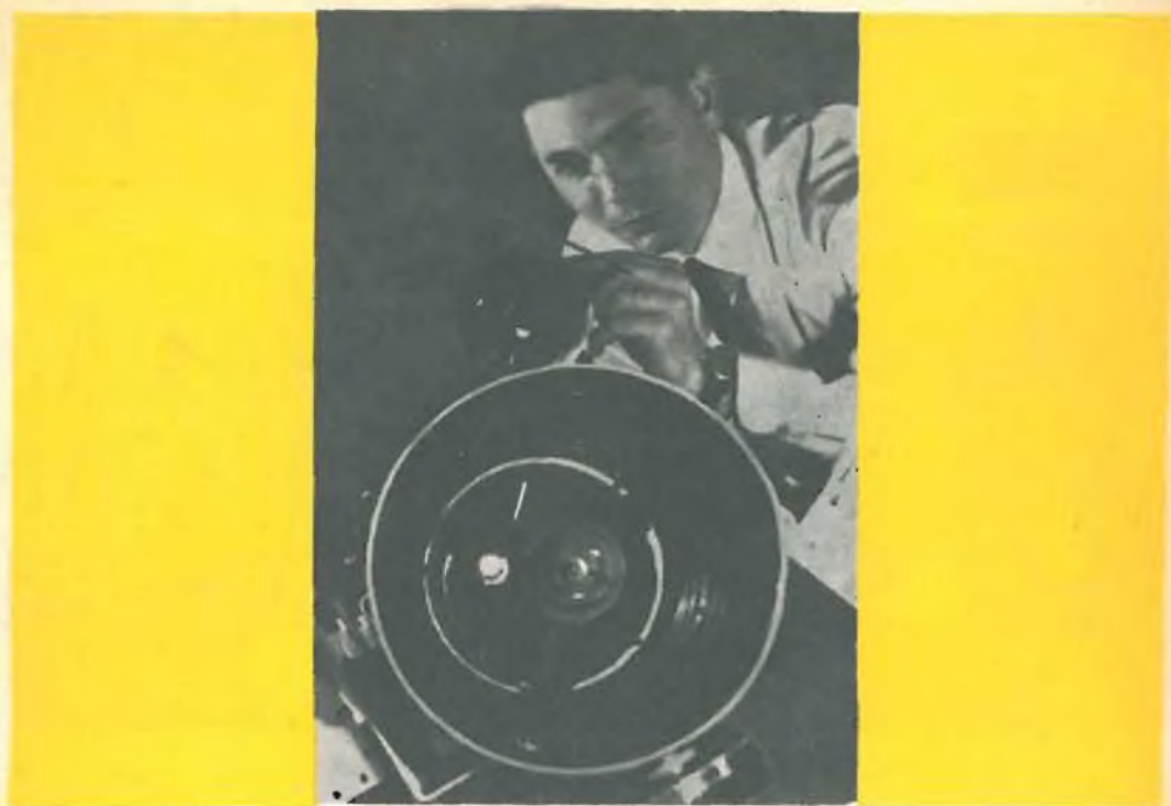
Prova di un maser ottico installato nei laboratori della Bell Telephone per esperimenti di telecomunicazione. I lampi emessi dal maser furono ricevuti da un fototubo a Murray Hill. N.J., distante 25 miglia.
