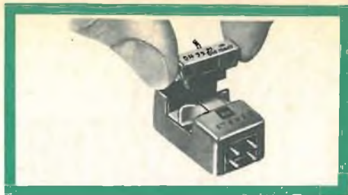
Fig. 2 - Pick-up magnetico, stereo DMS 900, con puntina diamante 'DN 95' per microsolco e stereo.
