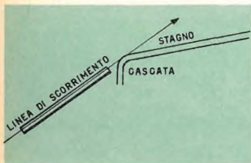
Fig. 6 - Rappresentazione schematica di una saldatrice « a cascata ».
