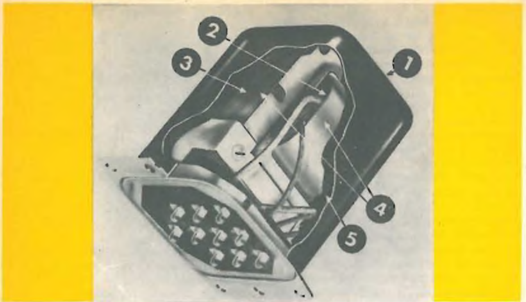
Fig. 17 - Dettagli costruttivi di un trasformatore di bassa frequenza. 1) Custodia metallica per la schermatura magnetica ed elettrostatica. 2) Struttura dell'avvolgimento. 3) Lamierini. 4) Il nucleo e l'avvolgimento vengono impregnati con sostanze isolanti. 5) Riempitivo per la protezione contro l'umidità.
