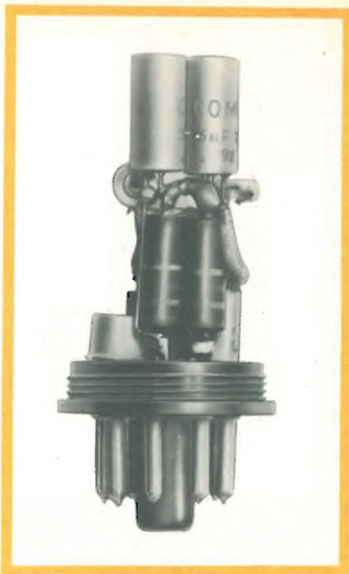
"Flip-flop" di potenza montato su zoccolo octal.
