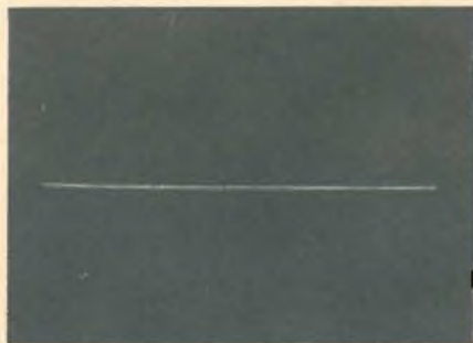
Fig. 2 - Sullo schermo è presente soltanto una riga orizzontale molto brillante. Il resto della superficie dello schermo è oscurato. Il suono è normale.
