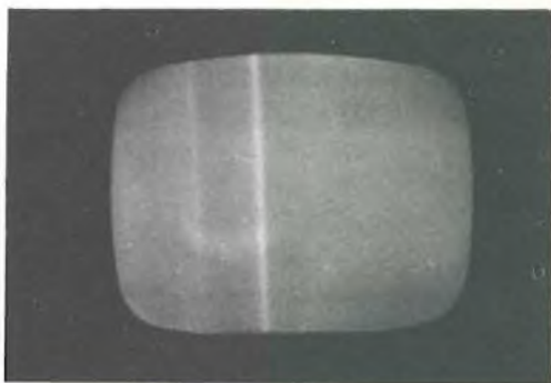
Fig. 5 - Sullo schermo, specialmente in assenza di immagini, sono presenti due righe verticali.
