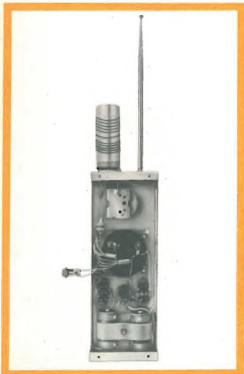
Fig. 3 - Interno dell'indicatore di campo e dell'ondametro a transistor.
