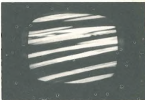
Fig. 1 - Agendo sui normali comandi esterni non è possibile ottenere il sincronismo orizzontale. Suono normale.
