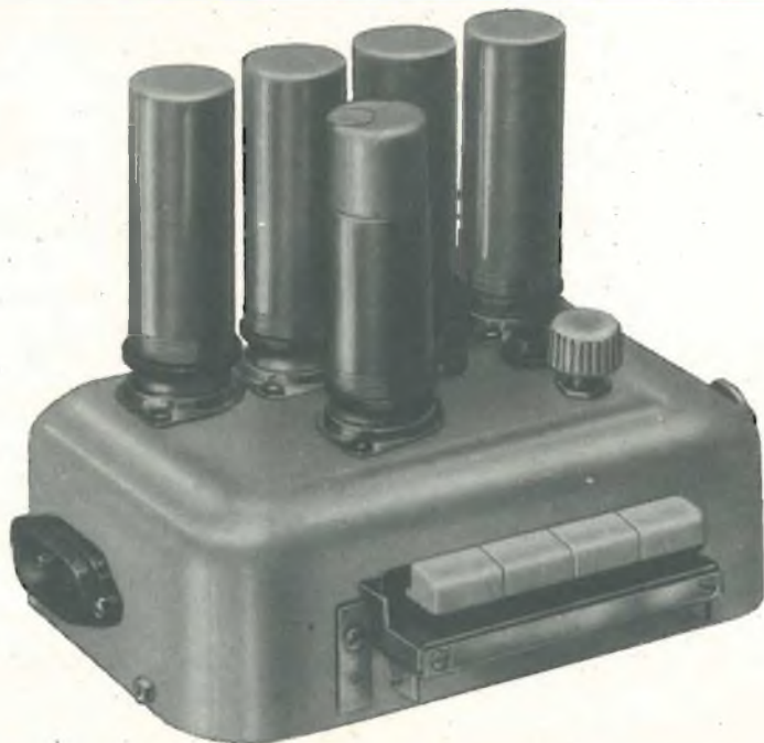
Fig. 5 - L'amplificatore formato con i 5 gruppi ad inserzione octal visto dalla parte superiore.
