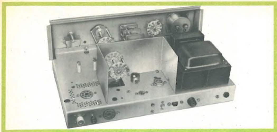
Telaio del trasmettitore «EICO» mod. 720 visto dalla parte superiore. Sono stati montati i principali componenti ma non è stato iniziato ancora il cablaggio.
