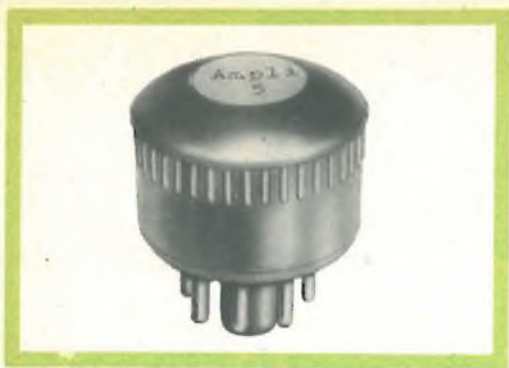
Fig. 2 - Aspetto esterno dell'amplificatore inseribile miniaturizzato Z/155-22. Scala 1:1.
