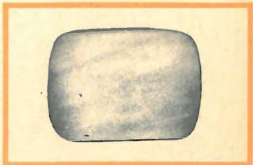
Raster caratteristico di anomalia al circuito di antenna (si hanno leggerissimi sintomi di presenza della stazione televisiva locale).
