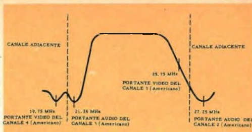
Fig. 23 - Tipica curva di risposta di media frequenza di un ricevitore per televisione.
