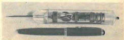
Fig. 1 - L'iniettore di segnali fotografato insieme ad una penna stilografica.
