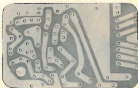
Fig. 3 - Pannello del circuito stampato del ricevitore RX a 8 canali pronto per essere cablato. Scala 1 : 1; dimensioni 3,65 X 5,7 cm.
