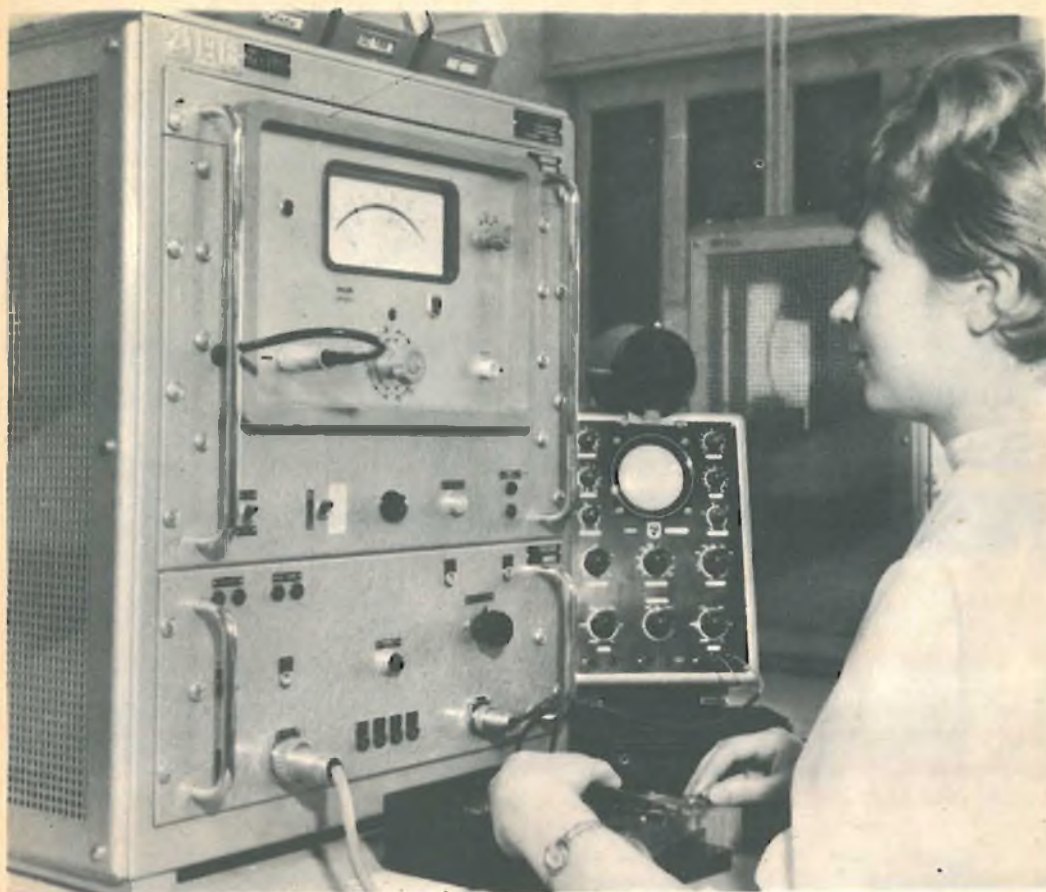
Misura della rumorosità e del crepitio del transistor Philips per alta frequenza.
