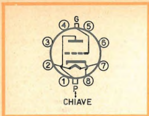
Fig. 2 - Zoccolatura della valvola « a corna » tipo 2C22 o 7193.
