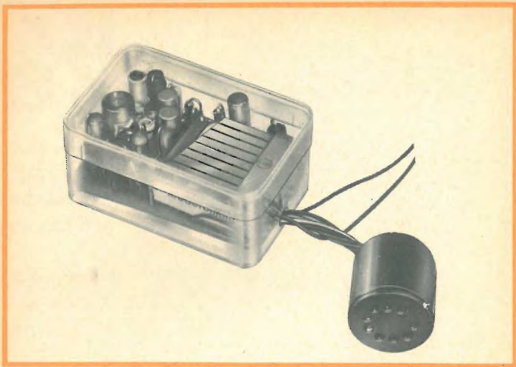
Fig. 1 - Ricevitore RX a 8 canali. Si noti in particolare lo spinotto a 9 piedini per il collegamento con il banco dei relè.
