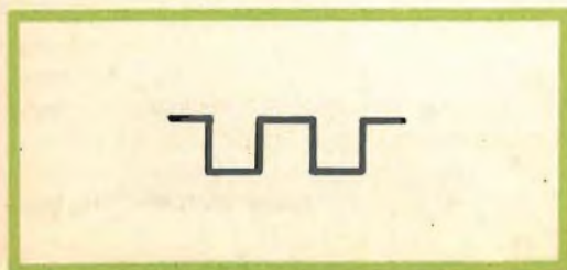
Fig. 3 - Oscillogramma della tensione di uscita.
