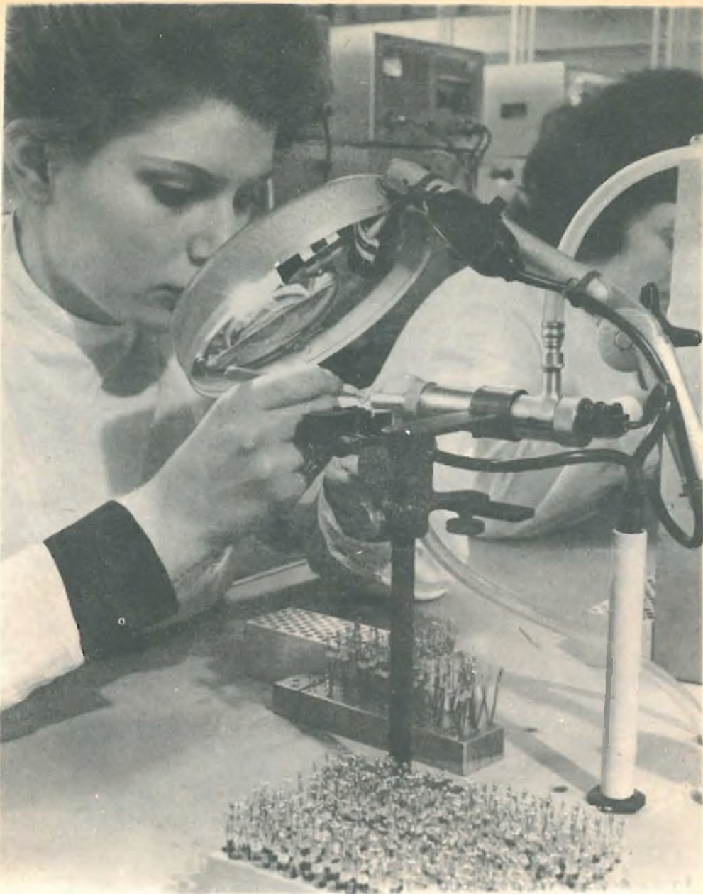
Fig. 9 - Aggraffatura dei transistor per bassa frequenza Philips.
