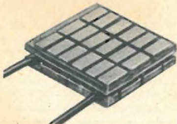
Fig. 6 - Unità refrigerante « Sirigor » con ponticelli di rame scoperti.
