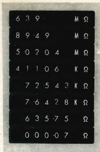
Fig. 2 - Indicazioni dell'ohmmetro nei singoli campi di misura digitale.
