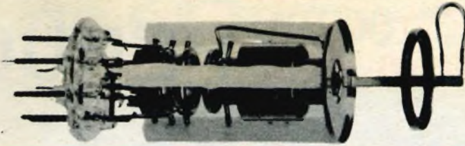
Fig. 14 - Cannone elettronico « unipotenziale » impiegato nel cinescopio « bonded » A 59-16 W.
