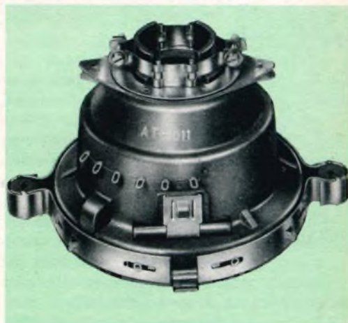
Unità di deflessione AT 1011/PM vista lateralmente per mettere in evidenza i magneti di correzione in "Ferroxidure"
