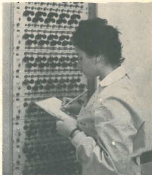
Fig. 1 - Pannello per la prova dei transistor (ATES).
