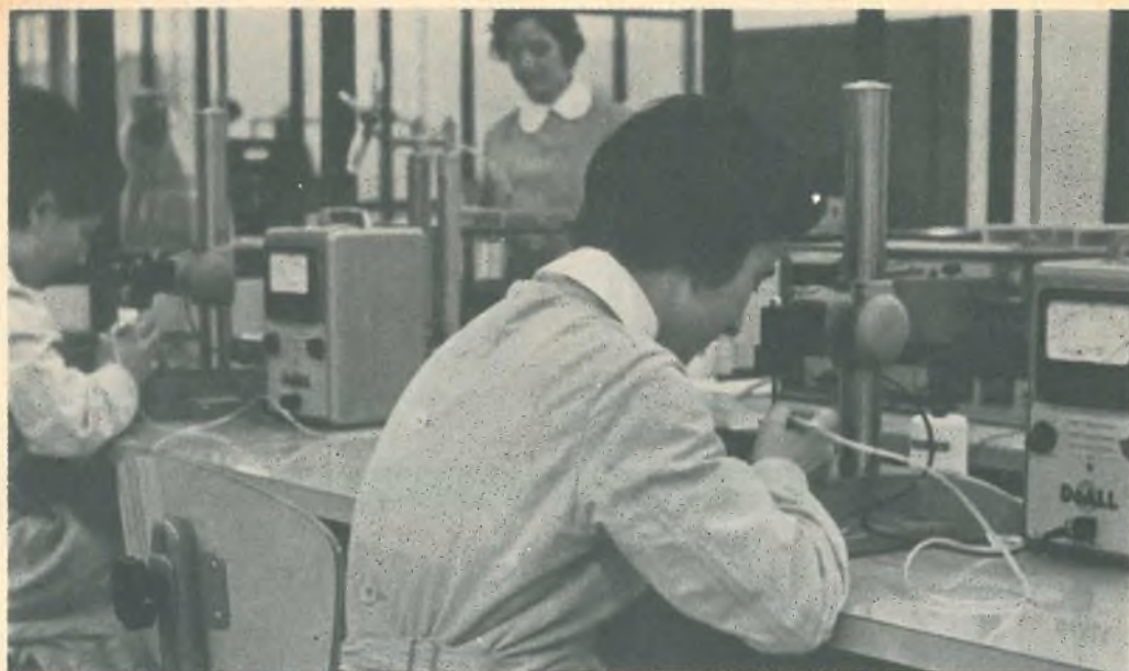
Fig. 2 - Misura dello spessore delle piastrelle di germanio (ATES)
