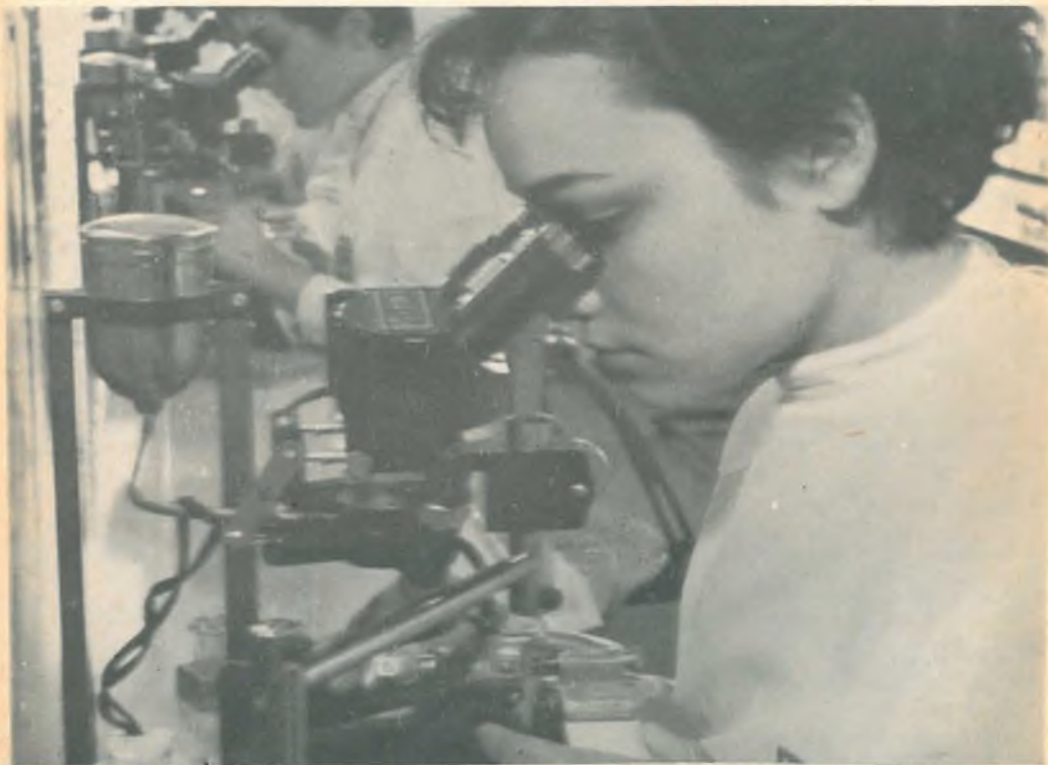
Controllo del contatto dei terminali di uscita di un transistor (base, collettore, emettitore) mediante microscopio binoculare.
