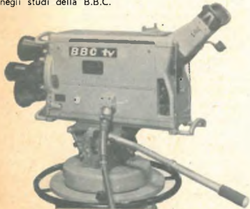
Una delle tante telecamere « Marconi Mark IV » usate negli studi della B.B.C.
