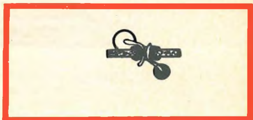
Fig. 4 - Particolare della giunzione su un rivetto.
