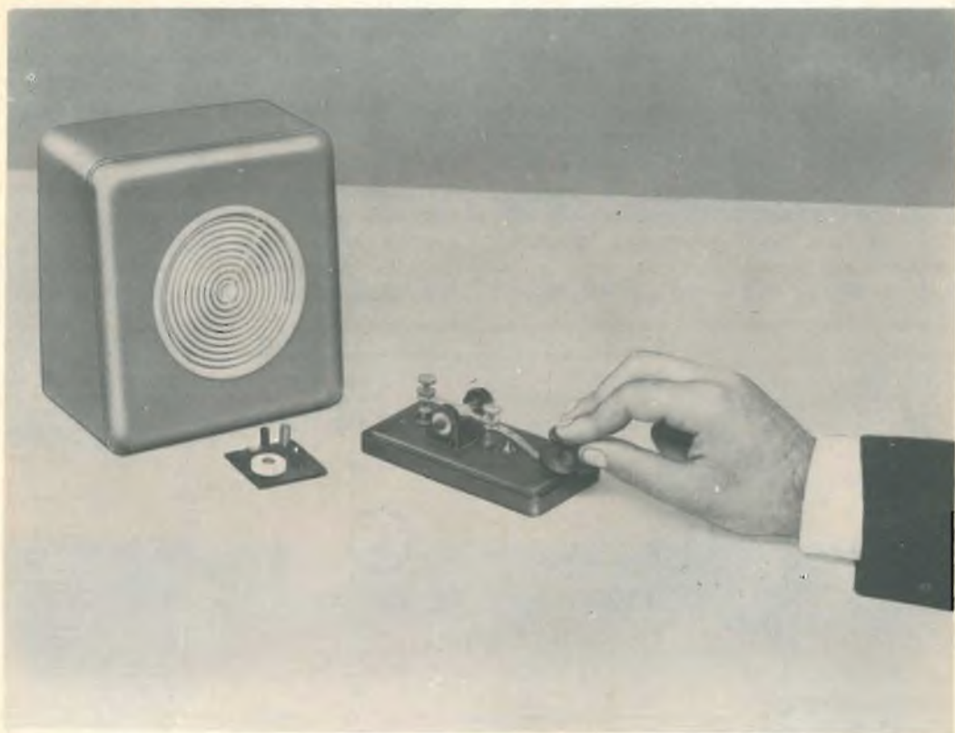
Oscillatore Morse: con il semplice apparecchio descritto è possibile sentire chiaramente in altoparlante la nota di bassa frequenza ritmicamente interrotta dal tasto Morse.
