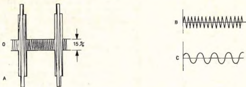
Fig. 4 - A) e B) Rapporti d'intensità dei segnali video e audio quando pervengono al rivelatore video. C) Battimento modulato in frequenza, di forma sinusoidale.
