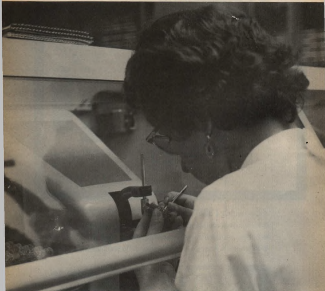
Montaggio del sistema elettrodico delle nuove valvole a dieci piedini «DECAL» (Philips).
