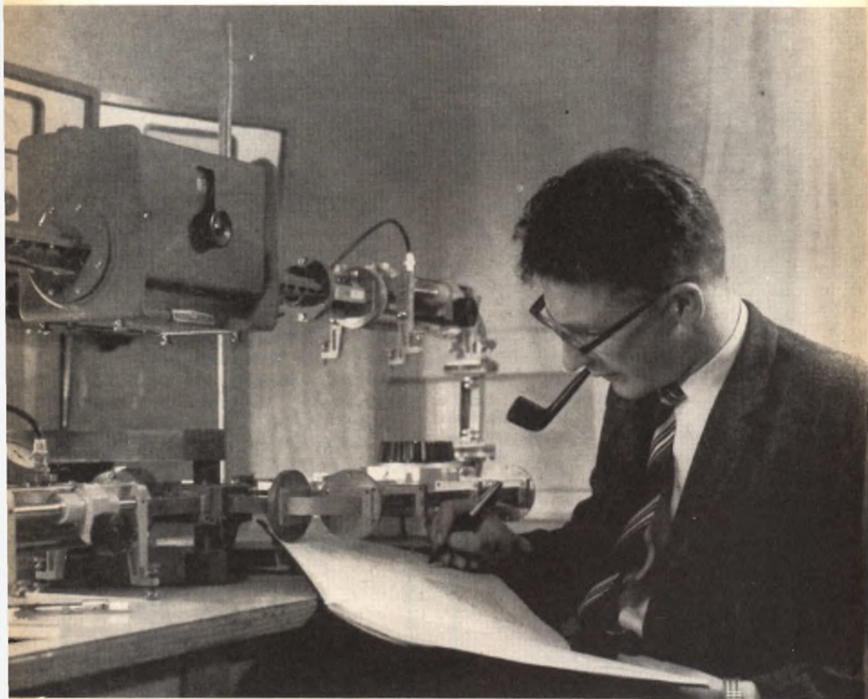
Un tecnico sta controllando il funzionamento di un tubo a onde progressive (TWT) su di un banco per microonde.
