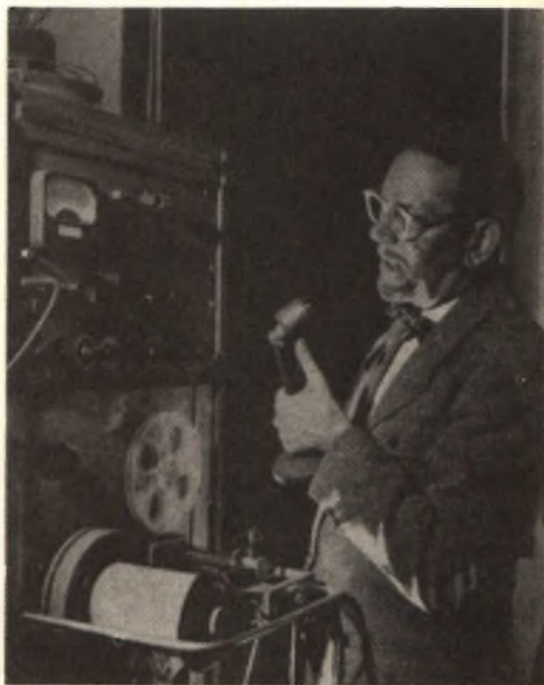
Fig. 1 - Spetrografo per l'analisi della voce. L'immagine della voce viene « stampata » sul rotolo di carta che si vede a destra.
