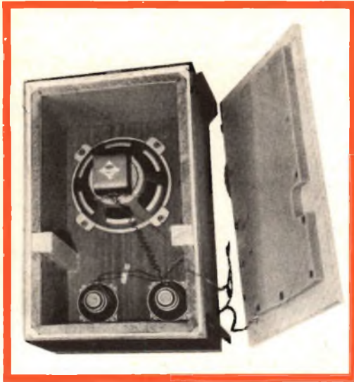
Fig. 3 - Cassa acustica di laboratorio che impiega gli altoparlanti A/463 ed A/458.
