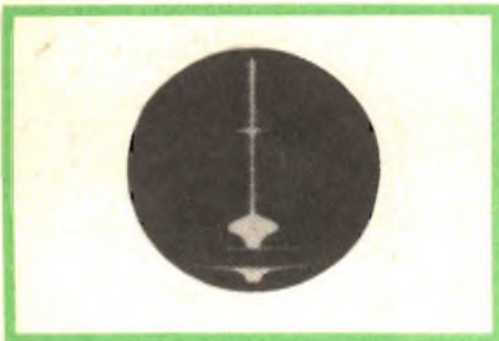
Fig. 4 - Indicazione su un tubo a raggi catododici di un pesce distante dal fondo del mare 14 m.
