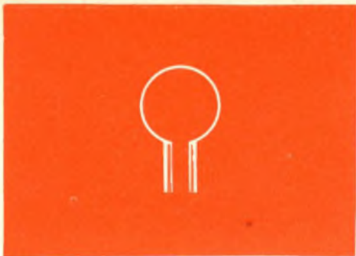
Fig. 2 - Semplice risonatore di Helmholtz.
