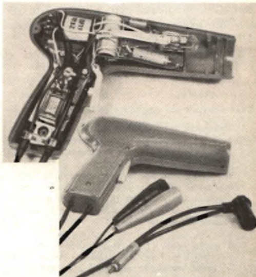
Fig. 1 - Pistola stroboscopica: si notano il cavo di alimentazione e il cavo che preleva l'impulso della scintilla.
