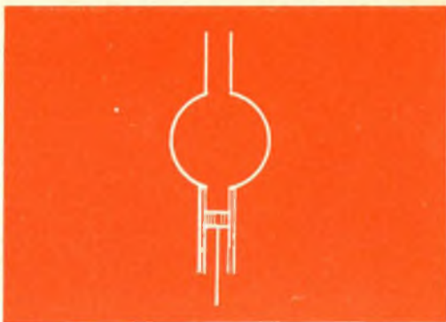
Fig. 3 - Risonatore di Helmholtz con pistone. L'escursione dell'aria nel condotto è massima alla frequenza di risonanza.
