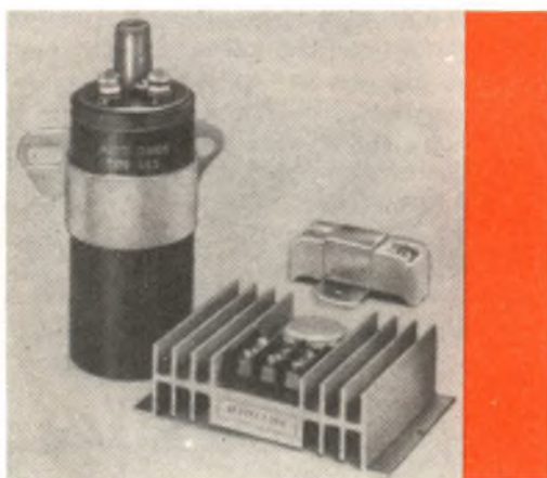
Fig. 4 - Realizzazione pratica del sistema di accensione a transistori proposta dalla ditta olandese Terminal di Amsterdam. Davanti si vede il transistoro di potenza montato sul suo radiatore, dietro è visibile l'aletta di raffreddamento con il diodo, a sinistra la bobina con rapporto di trasformazione di 1 : 250.
