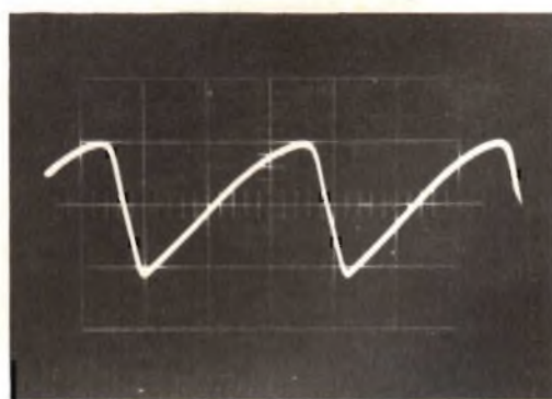
Corrente di deflessione ( I ). Orizzontale = 20 \mu\text{sec./divisione} . Verticale = 5 \text{ A/divisione} .
