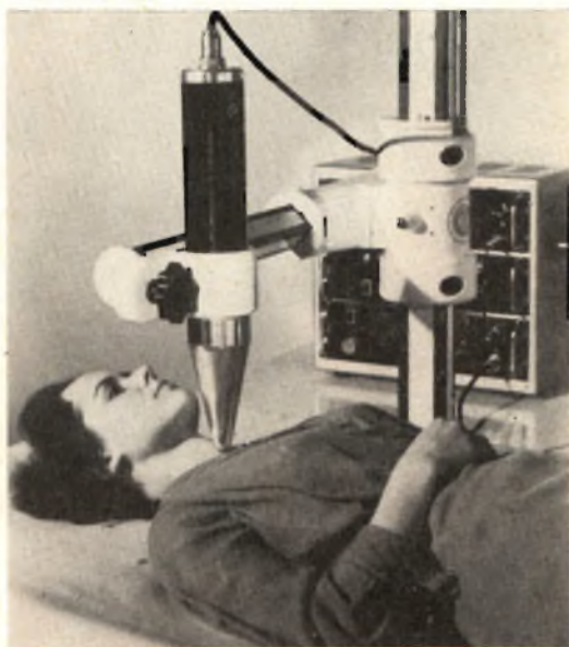
GLI ISOTOPICI IN MEDICINA - La presenza nella tiroide dell'iodio isotopo 131 può essere rivelata mediante questa sonda a scintillazione munita di collimatore. Le radiazioni emesse dallo iodio vengono convertite in luce da uno scintillatore e successivamente rivelate e amplificate da un fotomoltiplicatore. Sullo sfondo si possono vedere le apparecchiature impiegate per il conteggio delle scintillazioni.
