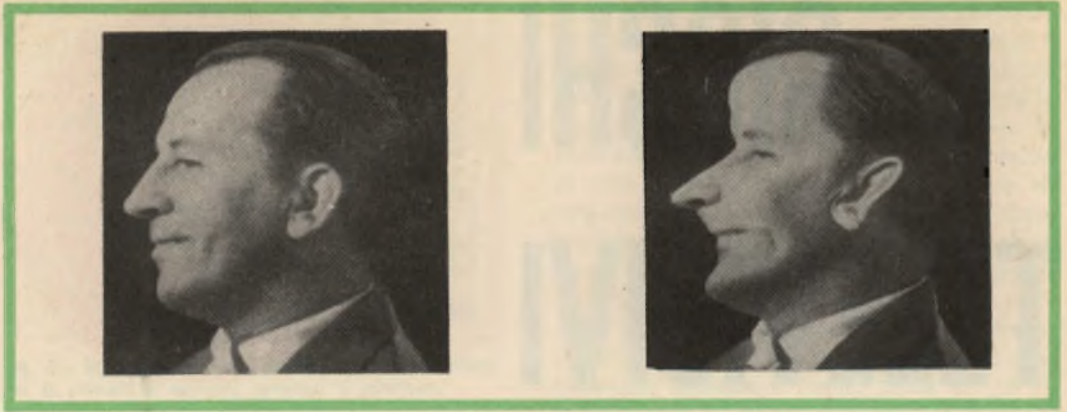
Fig. 3 - A sinistra ritratto normale, a destra deformazione di posizione con un segnale di 50 Hz.
