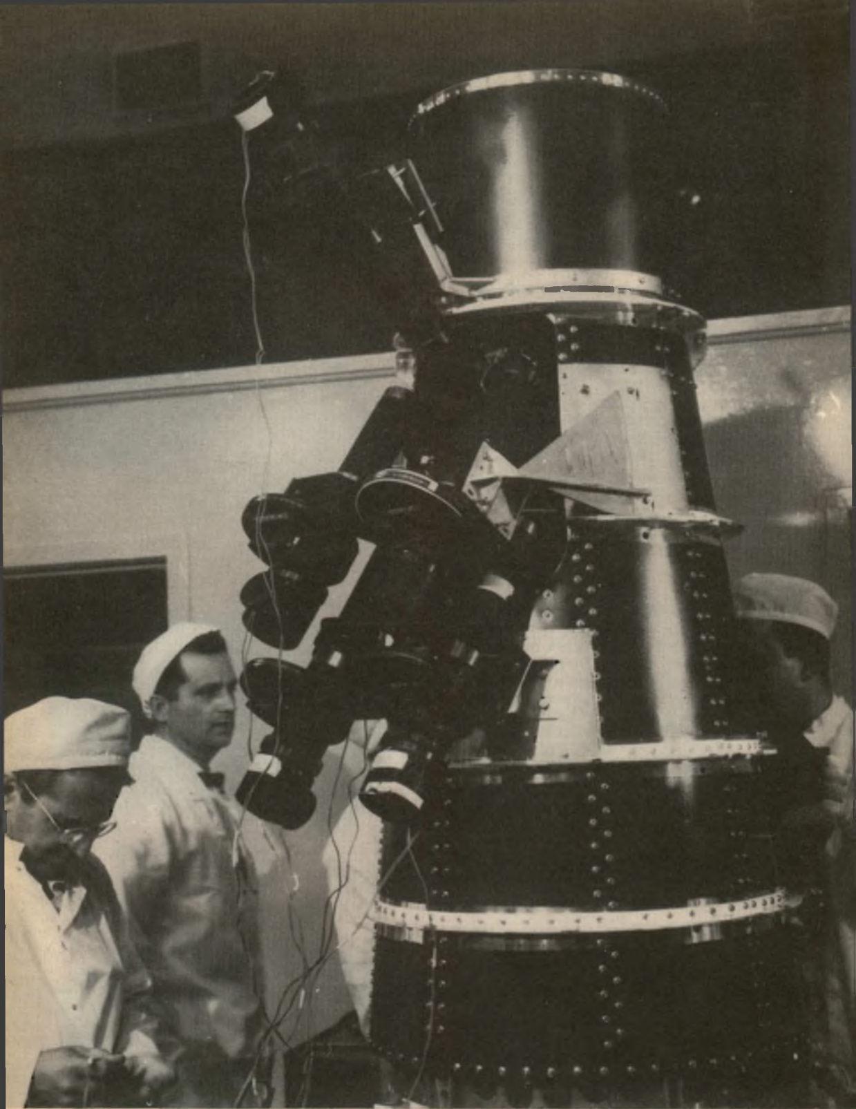
I tecnici della NASA a Cape Kennedy effettuano gli ultimi controlli delle telecamere piazzate a bordo del « Ranger VI » alla vigilia del lancio del veicolo.
