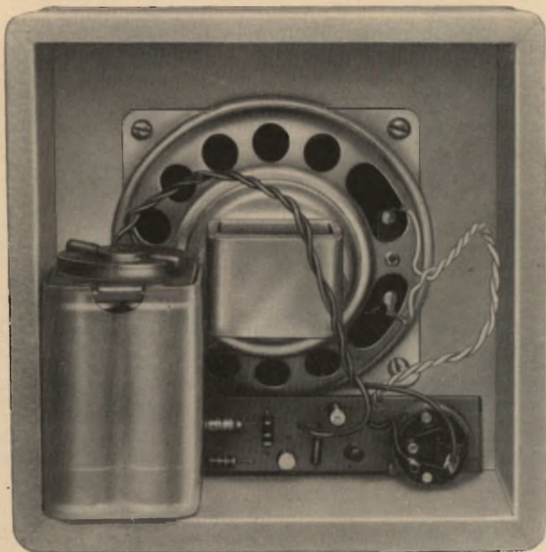
Fig. 5 - Il metronomo visto internamente: non contiene alcun pendolo o altro aggeggio meccanico, come si potrebbe credere sentendolo funzionare!
