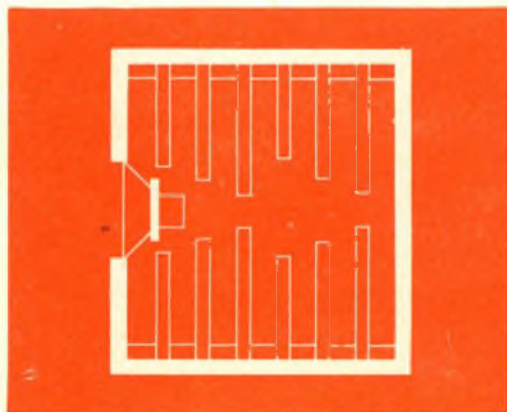
Fig. 9 - Cassa acustica con pannelli interni ideata da Hartley per eliminare completamente le risonanze dovute alle pareti e alla massa d'aria all'interno.
