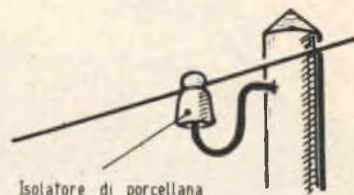
Isolatore di porcellana
