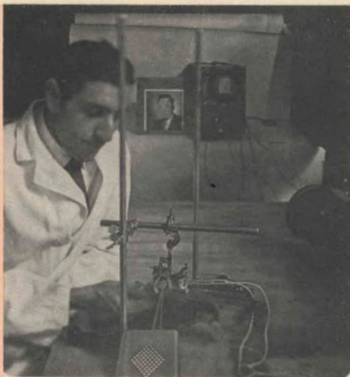
Fig. 3 - Il raggio di luce coerente prodotto dal laser effettua la scansione della fotografia in sincronismo con la base dei tempi dell'oscilloscopio. La luce riflessa dalla fotografia è inviata ad un tubo fotomoltiplicatore che modula l'asse Z del tubo a raggi catodici dell'oscilloscopio.
