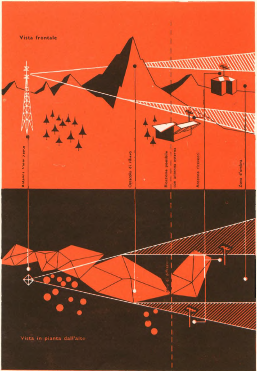
Fig. 6 - Esempio di propagazione delle onde metriche (zone di diffrazione).
