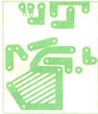
Fig. 6 - Circuito stampato del temporizzatore in scala 1 : 1.
