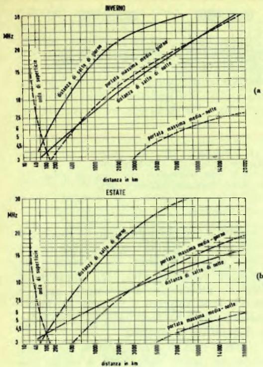
Fig. 4 - Grafici di propagazione delle onde corte in estate e in inverno, con una potenza del trasmettitore di 5 kW e una attività solare media.
