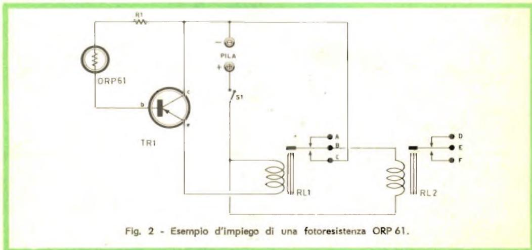
Fig. 2 - Esempio d'impiego di una fotoresistenza ORP 61.
