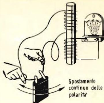
Se ora introduciamo nel secondo avvolgimento il polo di un magnete, l'indice dello strumento andrà in fondo scala come quando prima si chiudeva l'interruttore. Quando cessiamo di muovere il magnete, l'indice tornerà al centro (0). Se invertiamo le polarità del magnete e produciamo gli stessi movimenti di prima, l'indice dello strumento si comporterà come quando avevamo invertito le polarità dell'avvolgimento primario,
