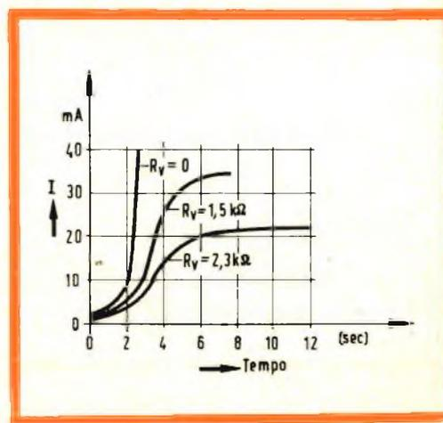
Fig. 34 - Variazione tipica della corrente in funzione del tempo in un termistore.
