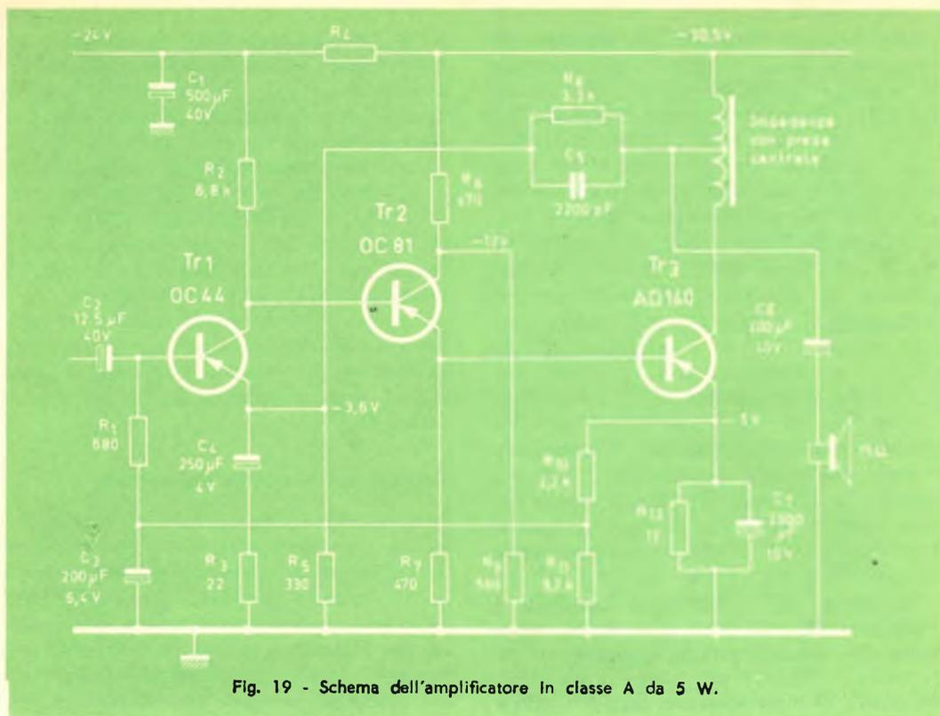
Fig. 19 - Schema dell'amplificatore in classe A da 5 W.
