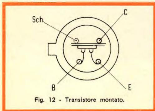
Fig. 12 - Transistore montato.
