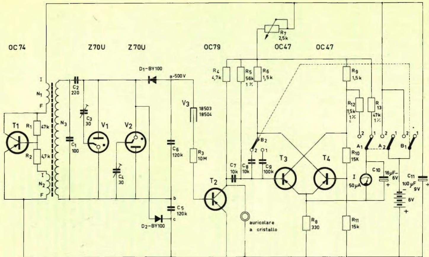
Fig. 3 - Schema elettrico del rivelatore di radiazioni.
