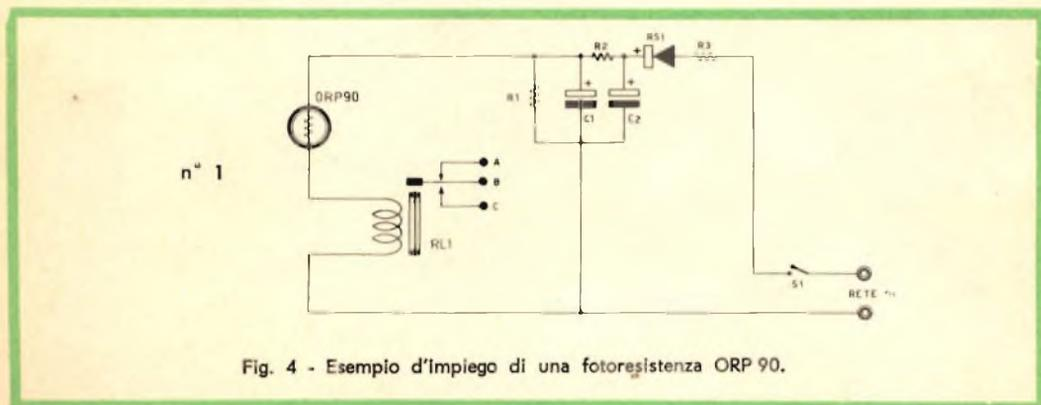
Fig. 4 - Esempio d'impiego di una fotosistenza ORP 90.
