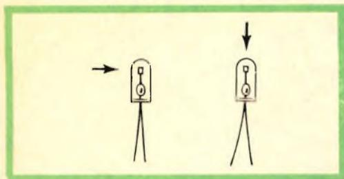
Fig. 3 - Differenti disposizioni dell'elemento sensibile nelle due fotosistenze ORP 90 e ORP 61.
