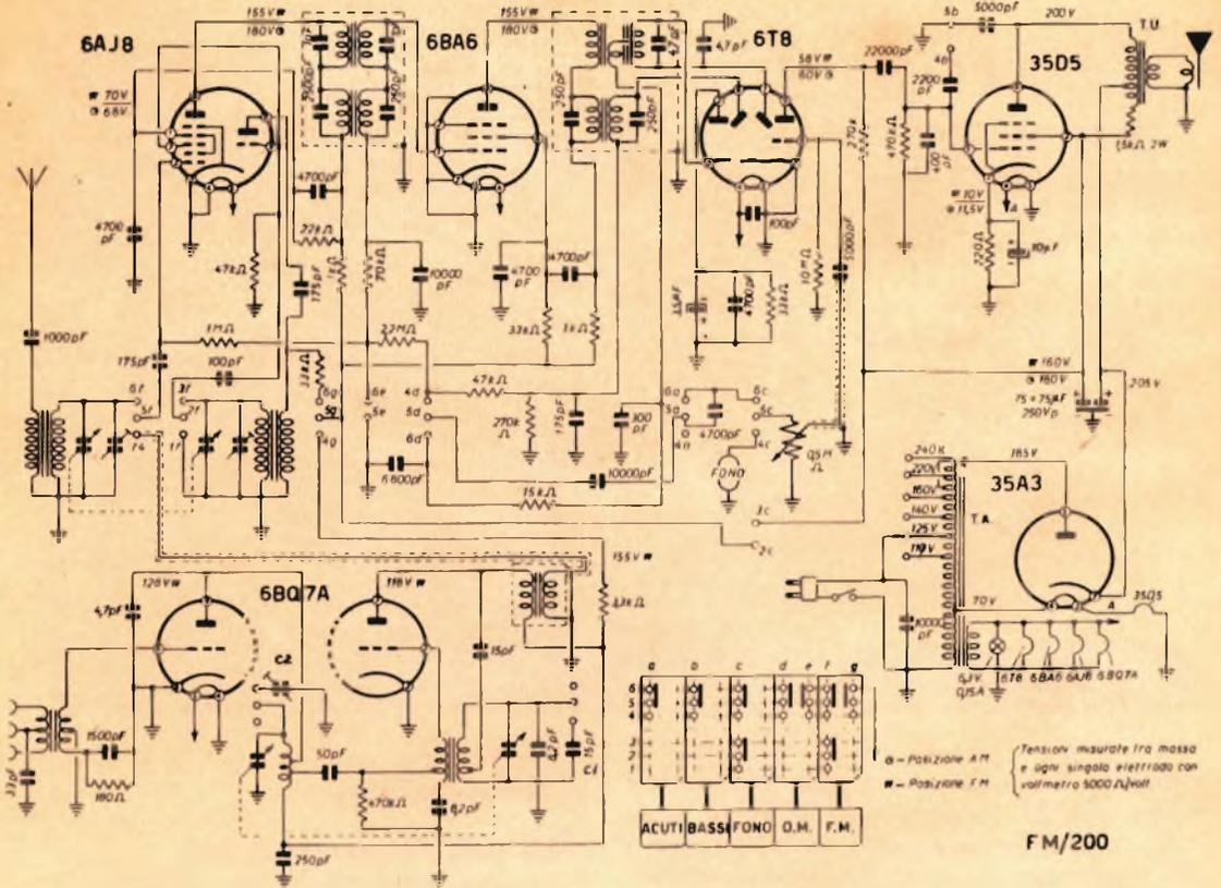
Fig. 1 - Schema elettrico del ricevitore FM/200.
