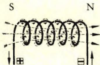
Se il conduttore di prima viene piegato in modo da formare una bobina, le linee di forza di cui abbiamo parlato prima si disporranno in modo da formare un campo magnetico uniforme all'interno della bobina alle cui estremità compariranno un polo Nord e un polo Sud.
