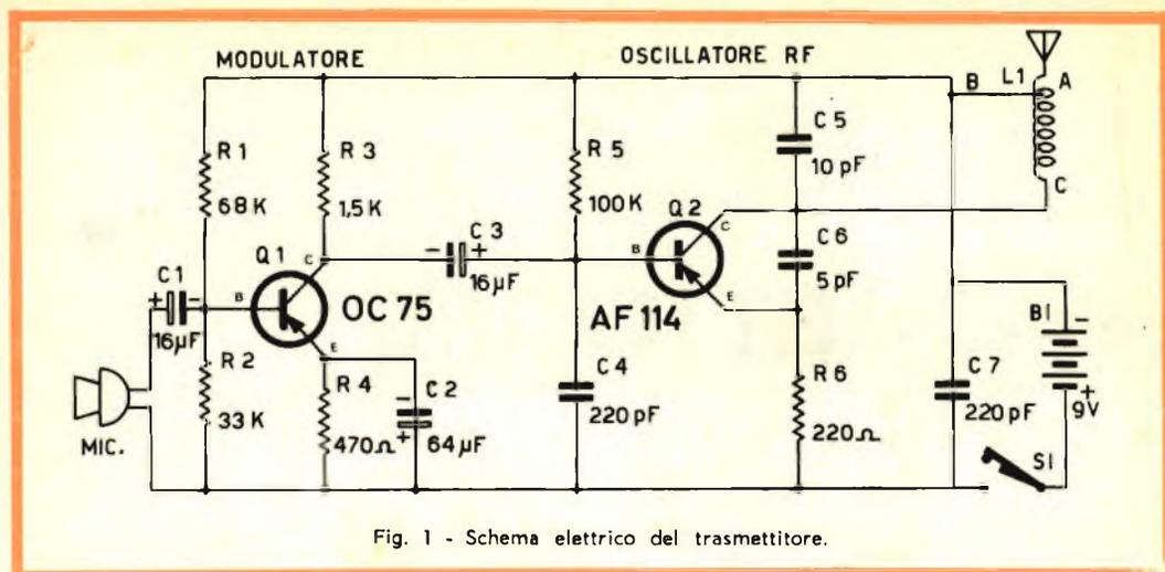
Fig. 1 - Schema elettrico del trasmettitore.
