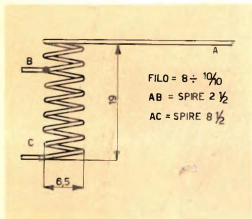
Fig. 2 - Particolare della bobina d'aereo.
