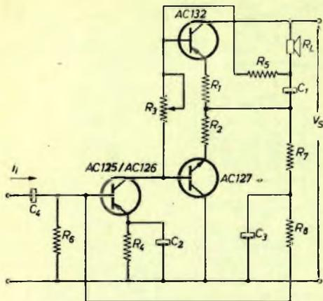
Fig. 1 - Schema elettrico dell'amplificatore complementare simmetrico in classe B.
