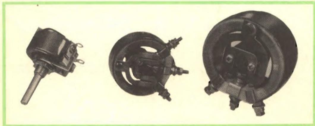
Tipici potenziometri di potenza smaltati. La tensione ammissibile è di circa 1200 V e la potenza massima è di 100 W ( $60^\circ\text{C}$ ).
