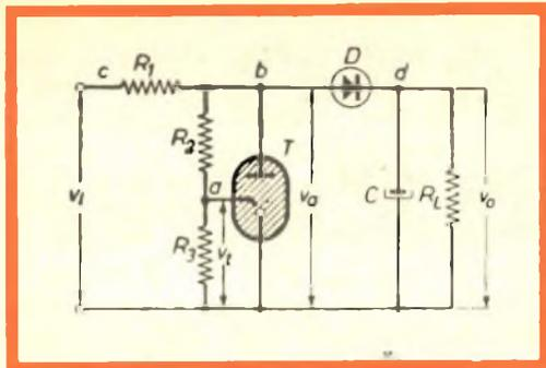
Fig. 1 - Schema elettrico dello stabilizzatore di tensione.
