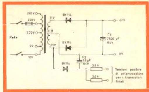
Fig. 22 - Schema elettrico dell'alimentatore per l'amplificatore da 10 + 10 W classe B.
