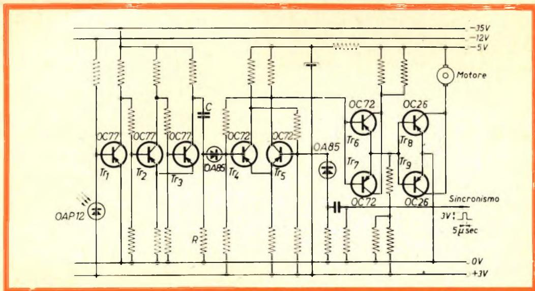
Fig. 3 - Schema elettrico dell'entità di controllo.
