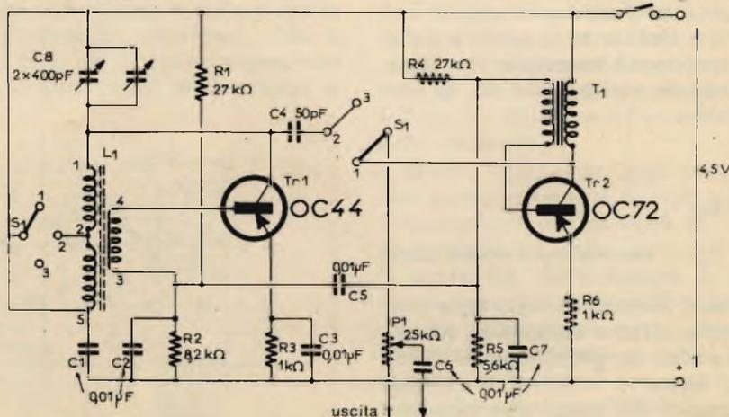
Fig. 1 - Schema elettrico del generatore a transistori.
