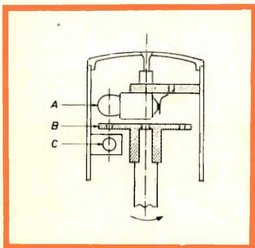
Fig. 1 - Realizzazione pratica della testina tachimetrica.
