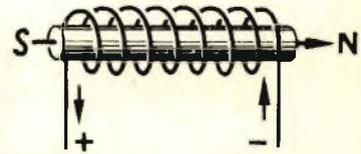
Una barretta di ferro si magnetizza se noi l'avvolgiamo con un filo percorso da corrente elettrica. Non ha importanza se la corrente è alternata o continua.
