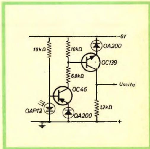
Fig. 2b - Variante del circuito di fig. 2a.
