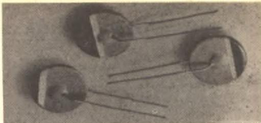
Resistenze VDR (Voltage Dependent Resistor) a disco. Sono chiamate anche varistori.
