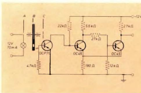
Fig. 2 - Schema elettrico della testina tachimetrica
