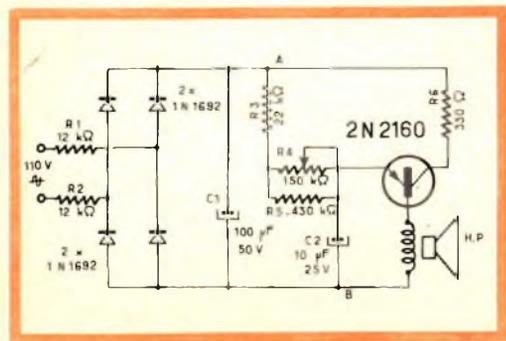
Fig. 1 - Schema elettrico di un metronomo elettronico.
