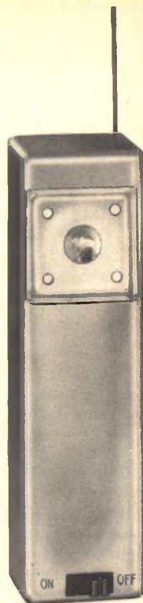
**P**ermette di irradiare sino a 100 metri di distanza segnali modulati ricevibili da un qualsiasi ricevitore a modulazione di frequenza, operante nella gamma  $88 \div 108$  MHz.
