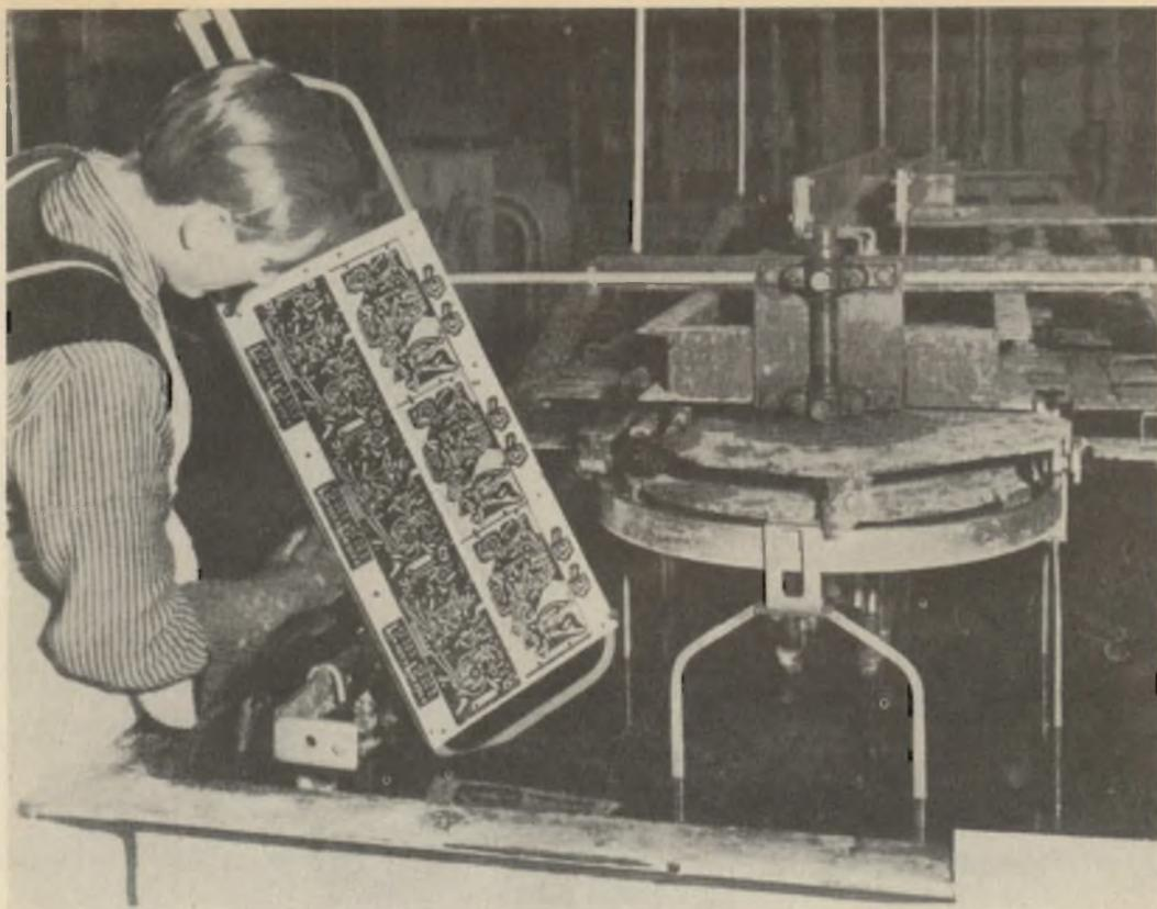
Pannello di circuito stampato prodotto interamente con processo elettroplastico.
