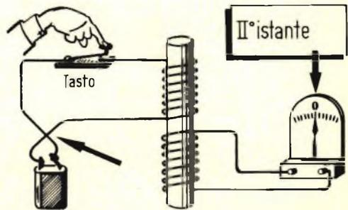
Se noi invertiamo le polarità della batteria collegata al primo avvolgimento, e ripetiamo l'esperienza di prima, vedremo che l'indice subirà le stesse oscillazioni; questa volta però in senso contrario a quelle di prima.
