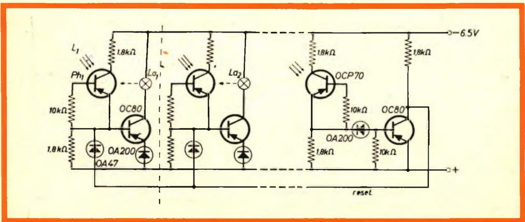
Fig. 1a - Schema elettrico della memoria luminosa.
