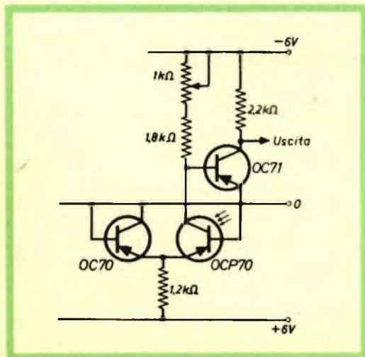
Fig. 2a - Circuito per la lettura dell'informazione trasmessa.
