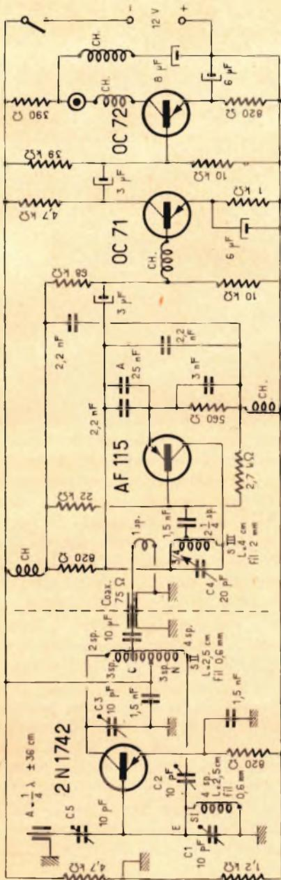
Fig. 1 - Schema elettrico dell'indicatore di Campo TV a transistori. Le bobine indicate con CH sono costituite da 16 spire unte di filo da 0,3 mm di diametro.
