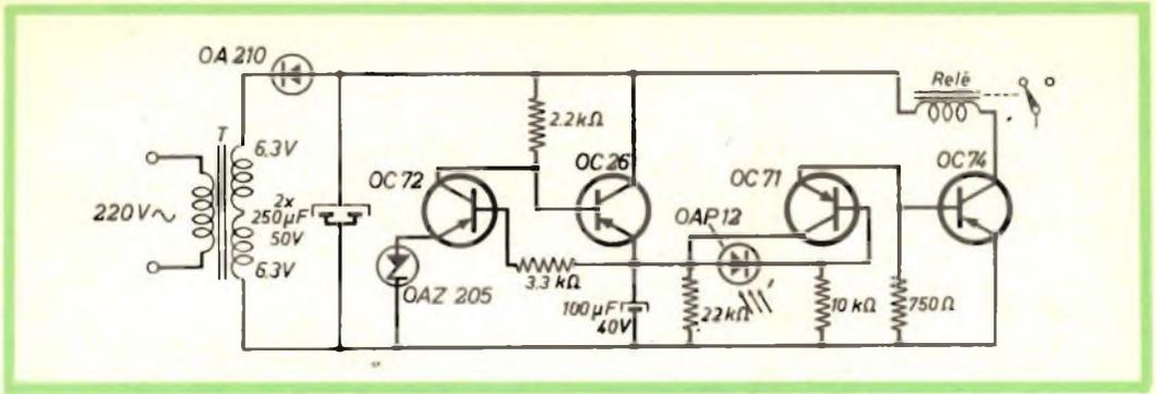
Fig. 2 - Schema elettrico del dispositivo regolatore.
