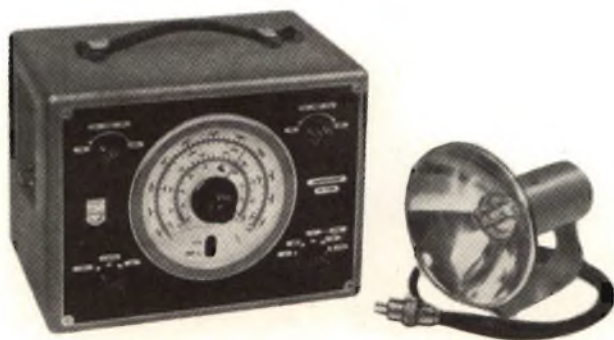
Stroboscopo PR9103/02 Philips composto da una unità di regolazione e da un proiettore separato.
