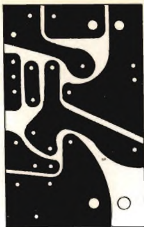
Fig. 4 - Il circuito stampato in grandezza naturale.
