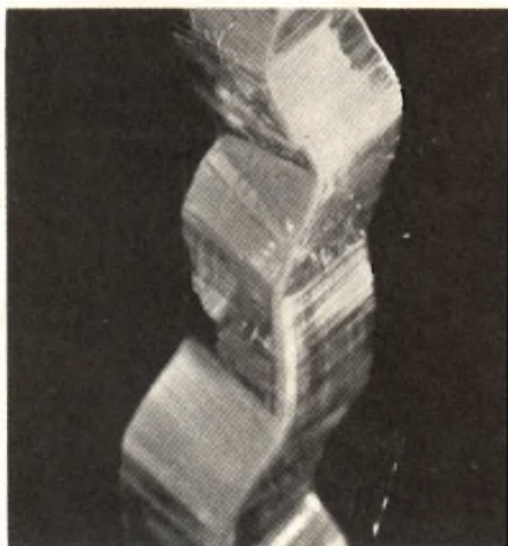
Fig. 17 - Microfotografia dell'incisione di un disco monofonico ingrandita 200 volte.
