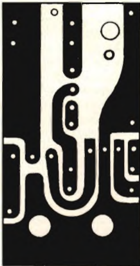
Fig. 3 - Il circuito stampato come si presenta in scala 1 : 1
