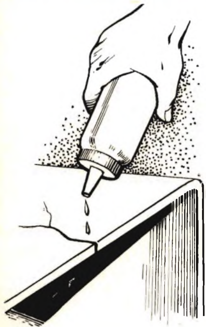
Fig. 3-4 - Altri esempi di impiego del Plas-T-Pair nella saldatura di incrinature e nella ricostruzione di sedi delle viti.
