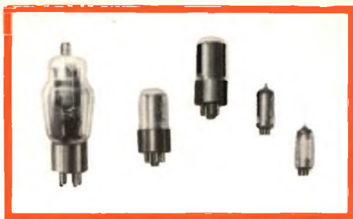
Fig. 4 - Esempi di valvole di produzione commerciale. I tipi di maggiori dimensioni appartengono alla vecchia produzione, sebbene alcuni esemplari vengano ancora prodotti, sia per consentire la sostituzione di quelle fuori uso, sia per i casi in cui occorra disporre di forti potenze. Gli esemplari di minori dimensioni fanno parte invece della produzione moderna.
