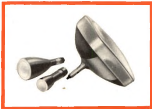
Fig. 5 - Esempi di tubi a raggi catodici. Sono costituiti da una parte tubolare, contenente il dispositivo che fornisce gli elettroni che urtano contro lo schermo, e da una parte ad imbuto, chiusa all'estremità dallo schermo stesso. Gli esemplari più piccoli vengono impiegati negli strumenti di misura, mentre i tipi di maggiori dimensioni servono per la realizzazione dei ricevitori televisivi.
