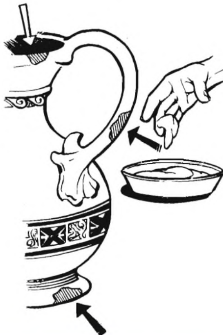
Fig. 1 - Esempio di impiego del Plas-T-Pair quale completamento di una parte mancante di ogni oggetto.
