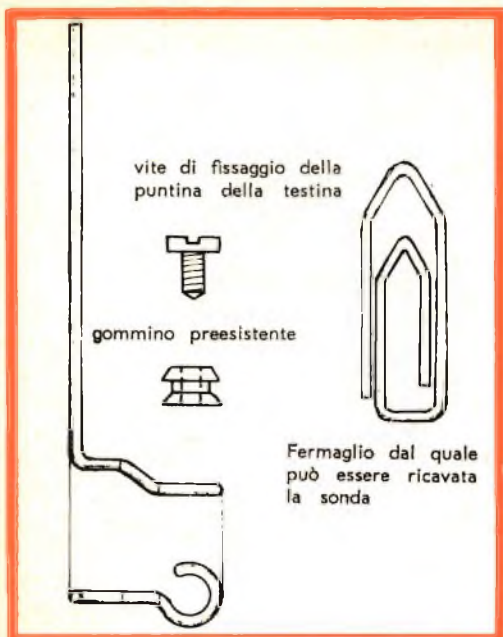
Fig. 4 - La sonda di rivelazione rumori riprodotta in scala 2:1. Essa può essere ricavata anche da un comune fermaglio fermacarte.
