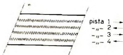
Fig. 1 - Esempio di nastro magnetico stereofonico suddiviso in quattro piste.
