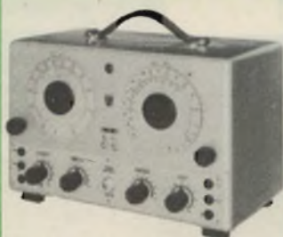
Sweep Marker VHF-UHF tipo GM 2877
