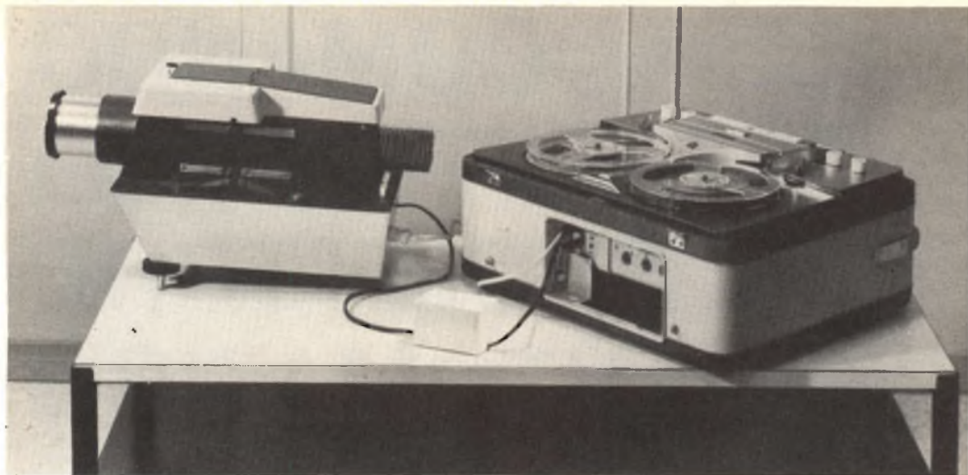
Fig. 2 - Vista di insieme del complesso di comando elettronico collegato al magnetofono e al proiettore per diapositive.
