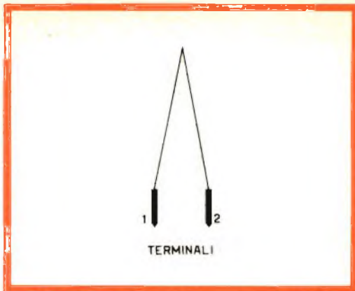
Fig. 1-A - Struttura fondamentale di un catodo a riscaldamento diretto. I due terminali (1 e 2) fanno capo ad altrettanti piedini facenti parte dello zoccolo della valvola. La tensione di accensione viene applicata appunto tra i suddetti piedini.
