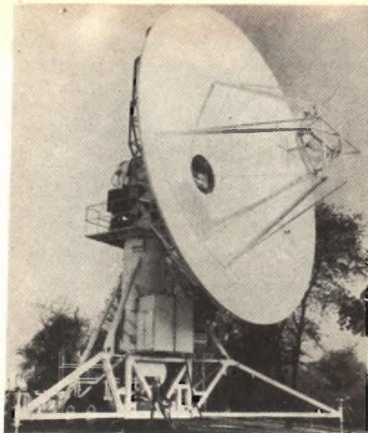
Fig. 5 - Antenna mobile adatta a captare i segnali trasmessi dai satelliti.
