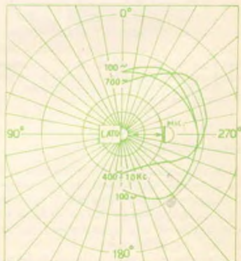
Fig. 9A - Pianta di radiazione polare per il piano orizzontale; fig. 9B - pianta di radiazione polare per il piano verticale.
