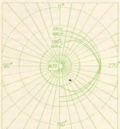
Fig. 9A - Pianta di radiazione polare per il piano orizzontale; fig. 9B - pianta di radiazione polare per il piano verticale.
