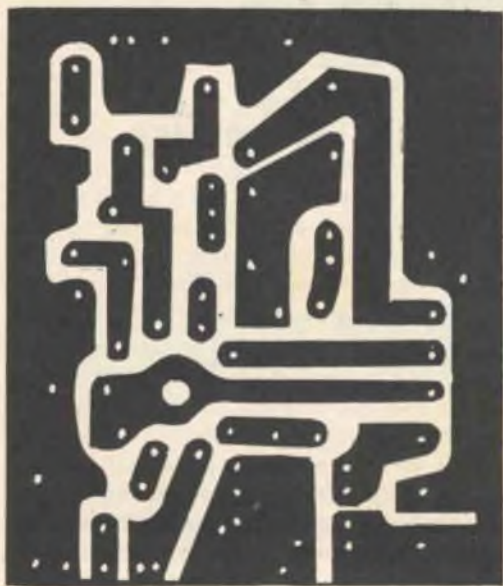
Fig. 2 - Riproduzione del circuito stampato in grandezza naturale
