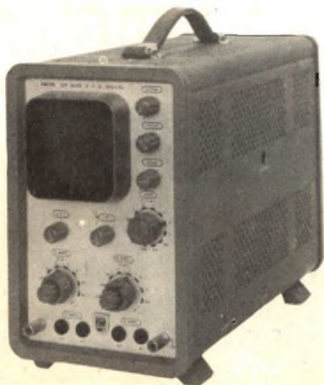
Esempio di nuovo oscilloscopio (GM 5606) per impieghi industriali di bassa frequenza e ultrasuoni. Sensibilità Y : 10 mV/div : Sensibilità X : 30 mV/div.
