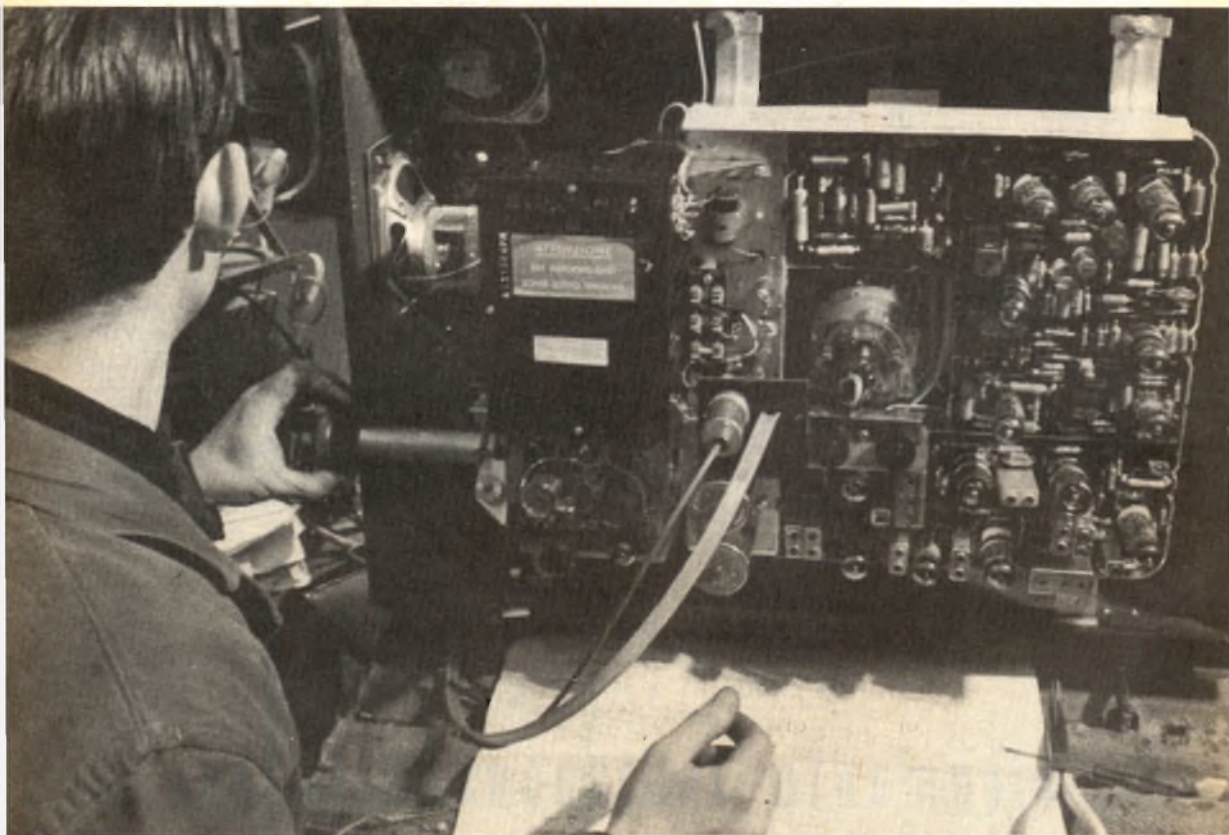
Controllo della sensibilità dei vari canali (sensibilità di antenna) in un televisore di produzione.
