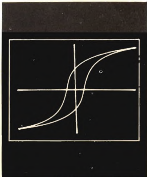
Ciclo d'isteresi di un materiale ferro magnetico ottenuto sullo schermo di un oscilloscopio.
