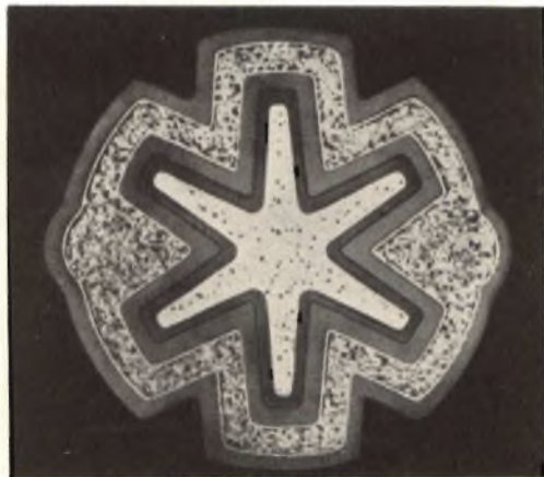
Costituzione interna del transistore al silicio planare epitassiale snowflake.
