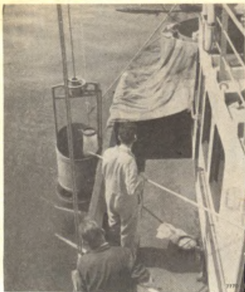
Fig. 5 - Studio sui movimenti delle sabbie dovuti alle correnti marine per mezzo di un radio-isotopo. Il materiale radioattivo (scandio-46, contenuto nella zeolite, un materiale granulare simile alla sabbia del Mar del Nord, mescolato con una certa quantità di sabbia) viene fornito in sacchi di plastica e vuotato in un recipiente metallico. La fotografia mostra come viene aperto un sacco mediante un coltello posto all'estremità di un lungo bastone. In primo piano è visibile un sacco vuoto. Il recipiente chiuso viene calato a mare, e quindi scaricato. Questo metodo è stato recentemente sostituito da un altro meno pericoloso, in quanto il radio-isotopo è posto nel recipiente dal fabbricante. (Fotografia scattata per gentile concessione del Delta Authority of the Dutch National Water Board).
