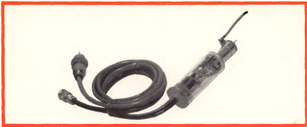
Fig. 10 - Fotografia della sonda con il suo cavo coassiale.
