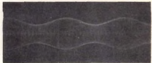
Osc. 4 d - Su questo oscillogramma è indicato ciò che succede quando si aggiungono le bande laterali della sottoportante. La sottoportante modulata in AM per poter riottenere la frequenza audio modulata può essere applicata ad un rivelatore AM.
