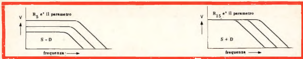
Fig. 15 - Influenza dei resistori variabili R_5 e R_{15} sulle risposte in frequenza dei segnali S—D e S + D.
