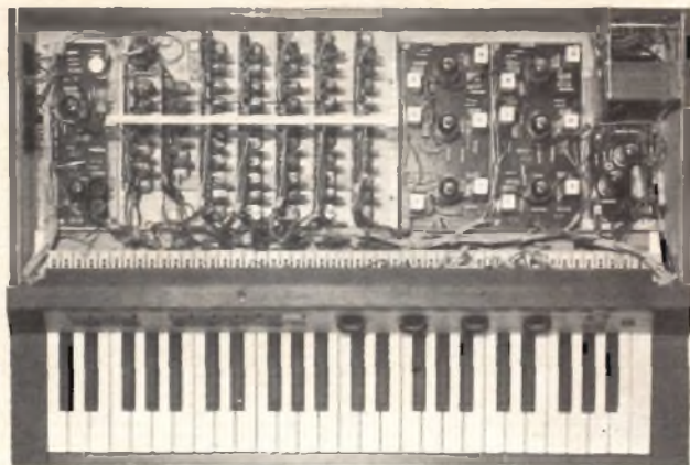
Fig. 3 - Vista interna del Philicorda dove si può vedere parte del circuito elettrico.
