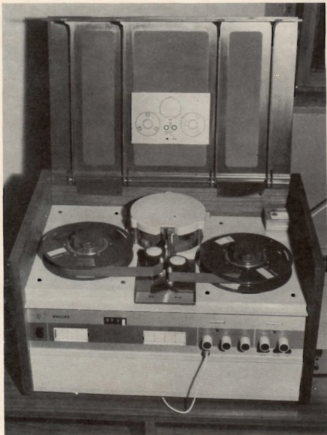
Fig. 1 - Aspetto del registratore video « Video Recorder 3400 » di produzione Philips. Il tamburo fisso, all'interno del quale si muove la testina ruotante, si trova tra le due bobine. La velocità del nastro è di 19 cm/sec.
